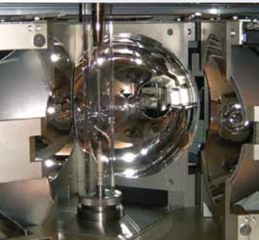
Ofen zur Einkristallzucht. Intensives Licht schmilzt ein polykristallines Probenstäbchen auf – beim langsamen Herausziehen aus dem Fokus erstarrt es als Einkristall
