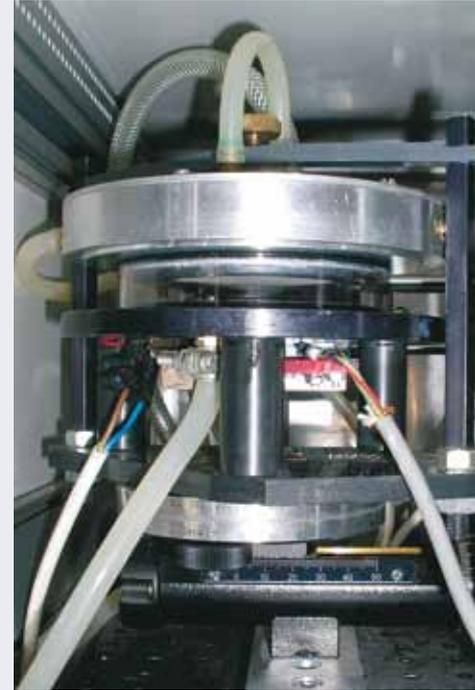
Blick in die Kammer des Wolkenkondensationskernzählers (entwickelt in unserer Gruppe) zur Erforschung der Bildung von Wolkentröpfchen
