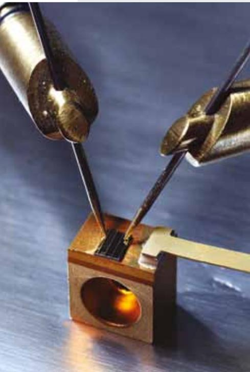
Ein Quantum Cascade Laser auf einem C-Mount wird mit feinen Testspitzen kontaktiert zur erstweiligen Qualitätsüberprüfung
