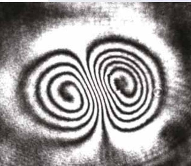
Spiral-Interferenz-Muster zur Vermessung der optischen Dicke von durchsichtigen Strukturen, wie z. B. biologischen Zellen
