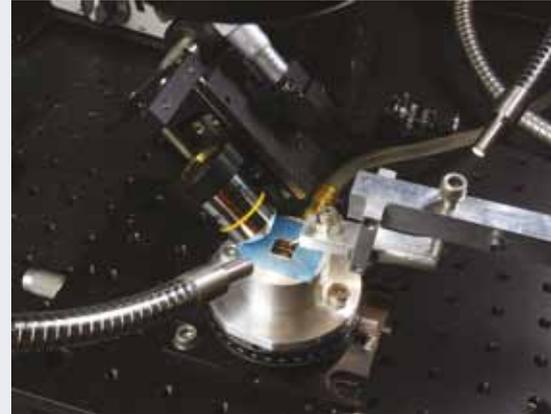
Ein Quantum Cascade Laser Chip wird mit Hilfe einer Diamantnadel unter dem Mikroskop in einzelne Laser aufgeteilt
