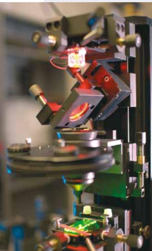
Nichtlineares optisches Mikroskop mit optischer Pinzette, mit dem die Dynamik von Zellen oder kleinsten chemischen Labors („lab-on-a-chip“) untersucht werden kann
