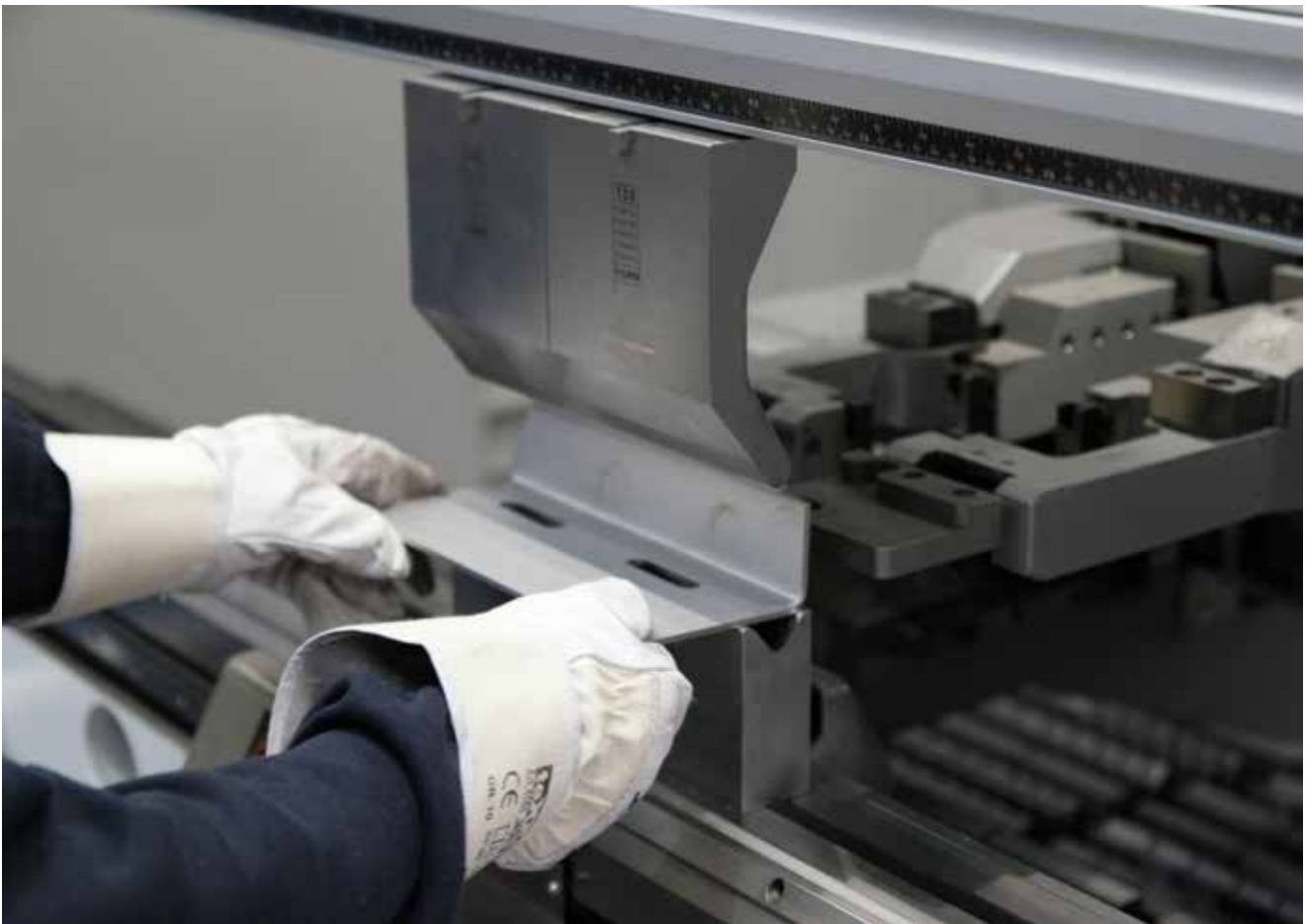
Bild 4: Neue automatisierte Abkantpressen ermöglichen durch sehr schnellen, robotergesteuerten Werkzeugwechsel eine besonders wirtschaftliche Produktion von nichtrostenden Profilen in Kleinserien (Foto: Wilhelm Modersohn GmbH & Co. KG, Spenge)
