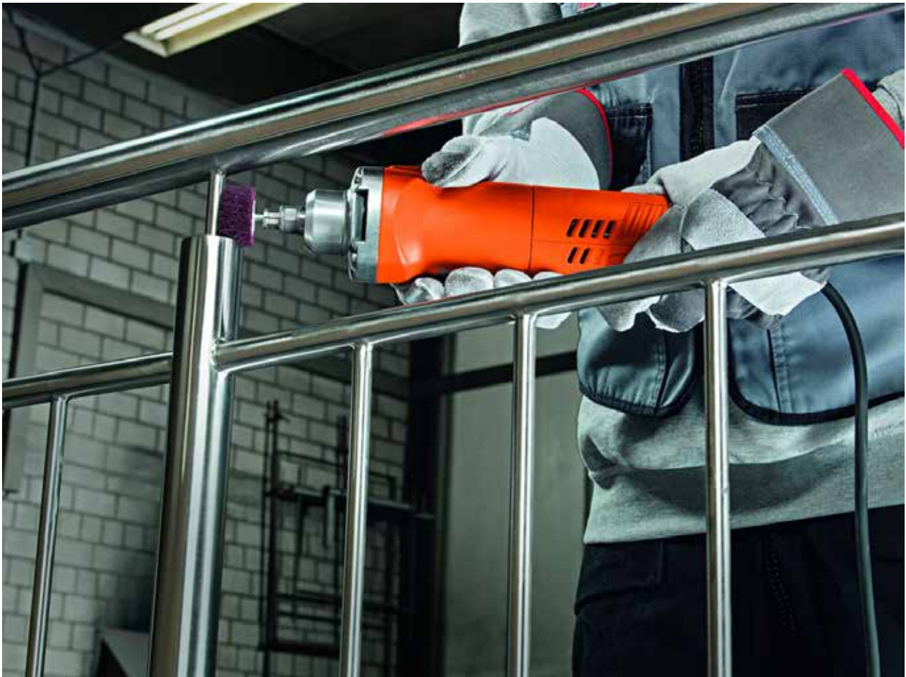
Bild 3: Zum Entfernen von Anlauffarben und Nacharbeiten von Schliffbildern an dekorativen Bauteilen stehen leistungsstarke Handschleifgeräte wie zum Beispiel dieser Geradschleifer zur Verfügung (Foto: C. & E. Fein GmbH, Schwäbisch Gmünd)
