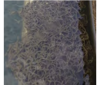
シラスウナギ専用魚道の中に充填されているヘチマロン
