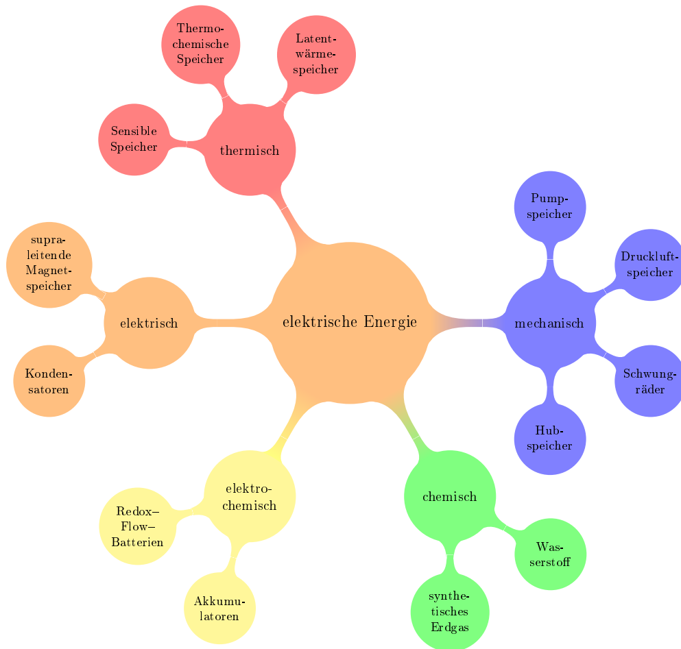
Abbildung 18: Systematik der Energiespeichertechniken.
