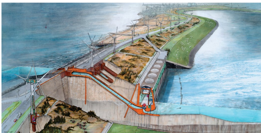
Abbildung 21: Schnittdarstellung des „Energy Island“ (Bild: KEMA Nederland B.V.).
