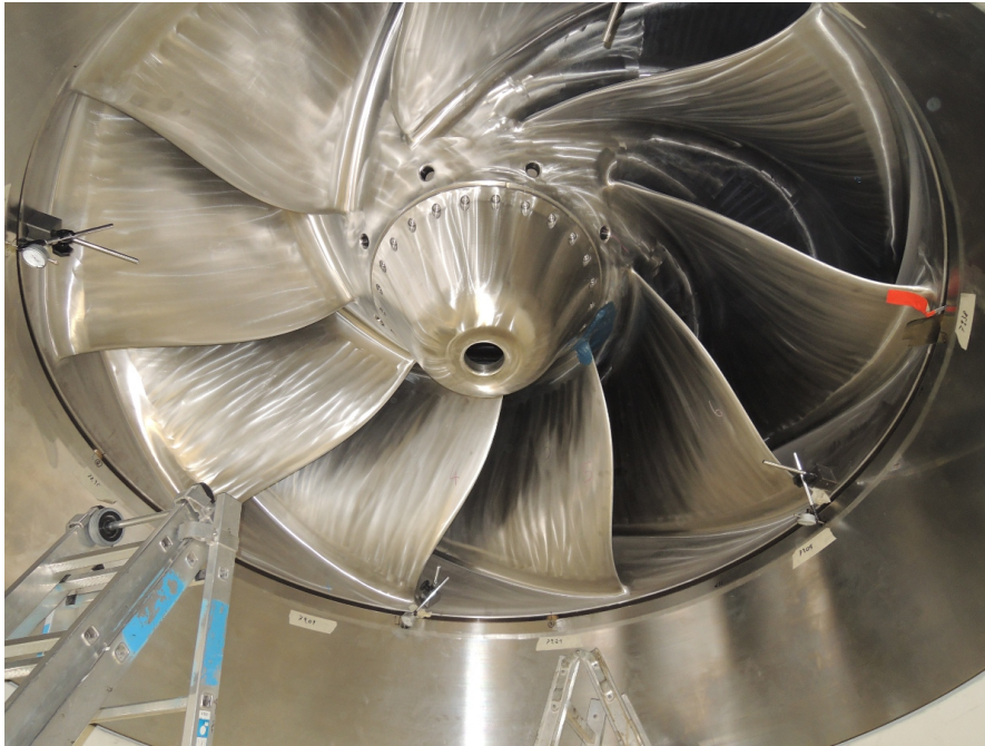
Abbildung 14: Laufrad der 200 MW reversiblen Pumpturbine.
