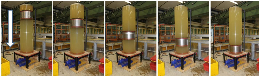
Abbildung 30: Versuchsaufbau eines Hubkolbenspeichers (Bild: Universität Innsbruck , http://www.powertower.eu/ ).
