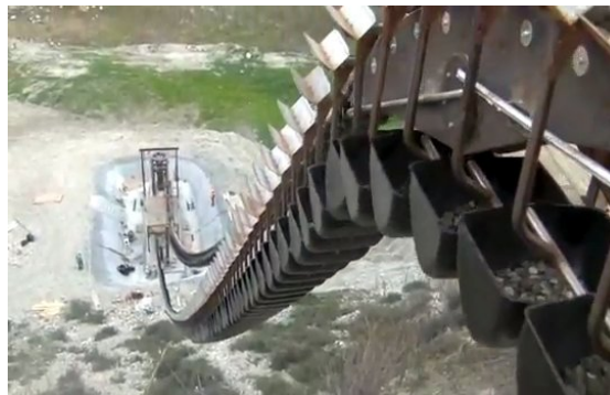
Abbildung 31: 50 kW Prototyp eines Eimerkettenspeichers (Bild: Energy Cache™, http://www.energycache.com/ ).
