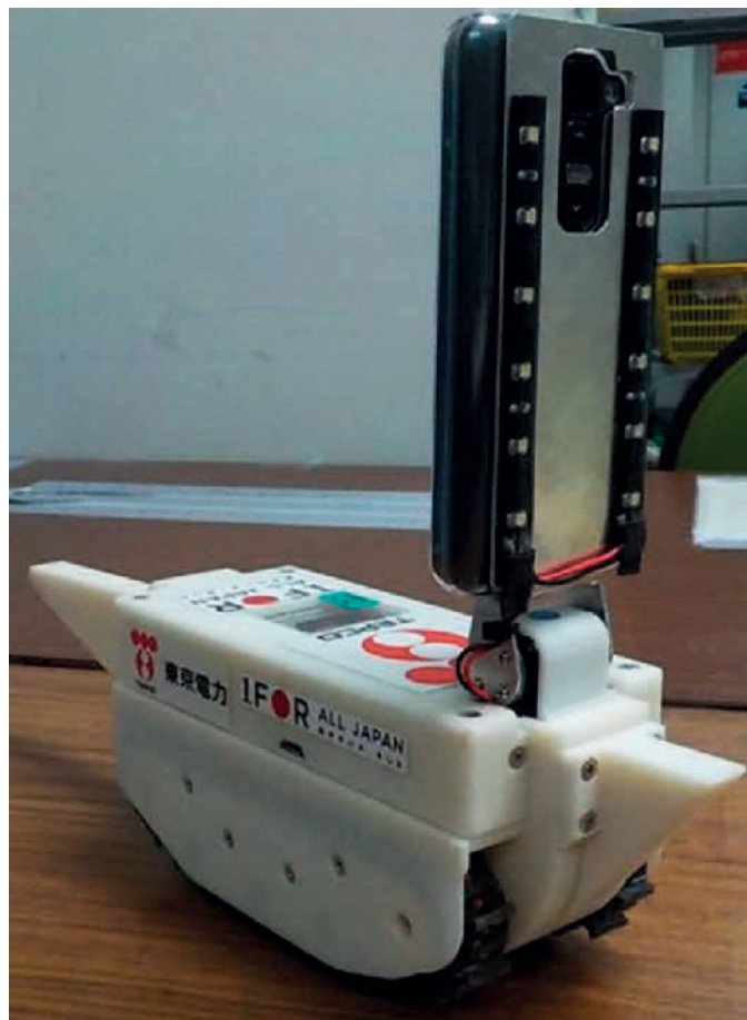
Abb. 6.35: Konstruktion aus einem Smartphone und einem ferngelenkten Raupenfahrzeug, mit der die Materialschleuse von Block 3 untersucht wurde (Quelle: TEPCO).
