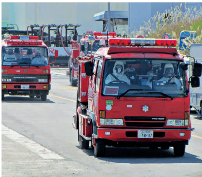
Abb. 3.21: Feuerwehrfahrzeuge auf dem Weg zum Anschluss mobiler Pumpen und zur Wassereinspeisung (Quelle: TEPCO).
