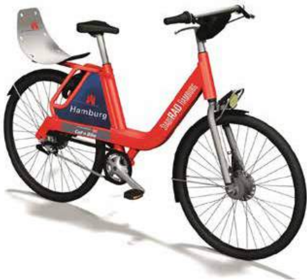
Bild 7.2: Neue Modellreihe der StadtRäder mit höherem Lenker und tieferem Durchstieg (Visualisierung: Deutsche Bahn Connect GmbH)
