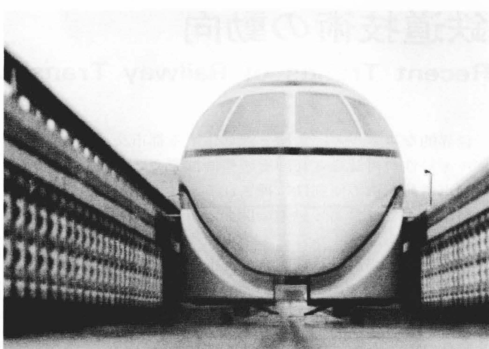
図4 浮上走行中の実験車 浮上式鉄道宮崎実験線では、昭和54年12月ML500により時速517kmの世界記録を樹立した。その後、ガイドウェイを従来の逆T形からU形に改造し、MLU 001による実験が繰り返されている。
