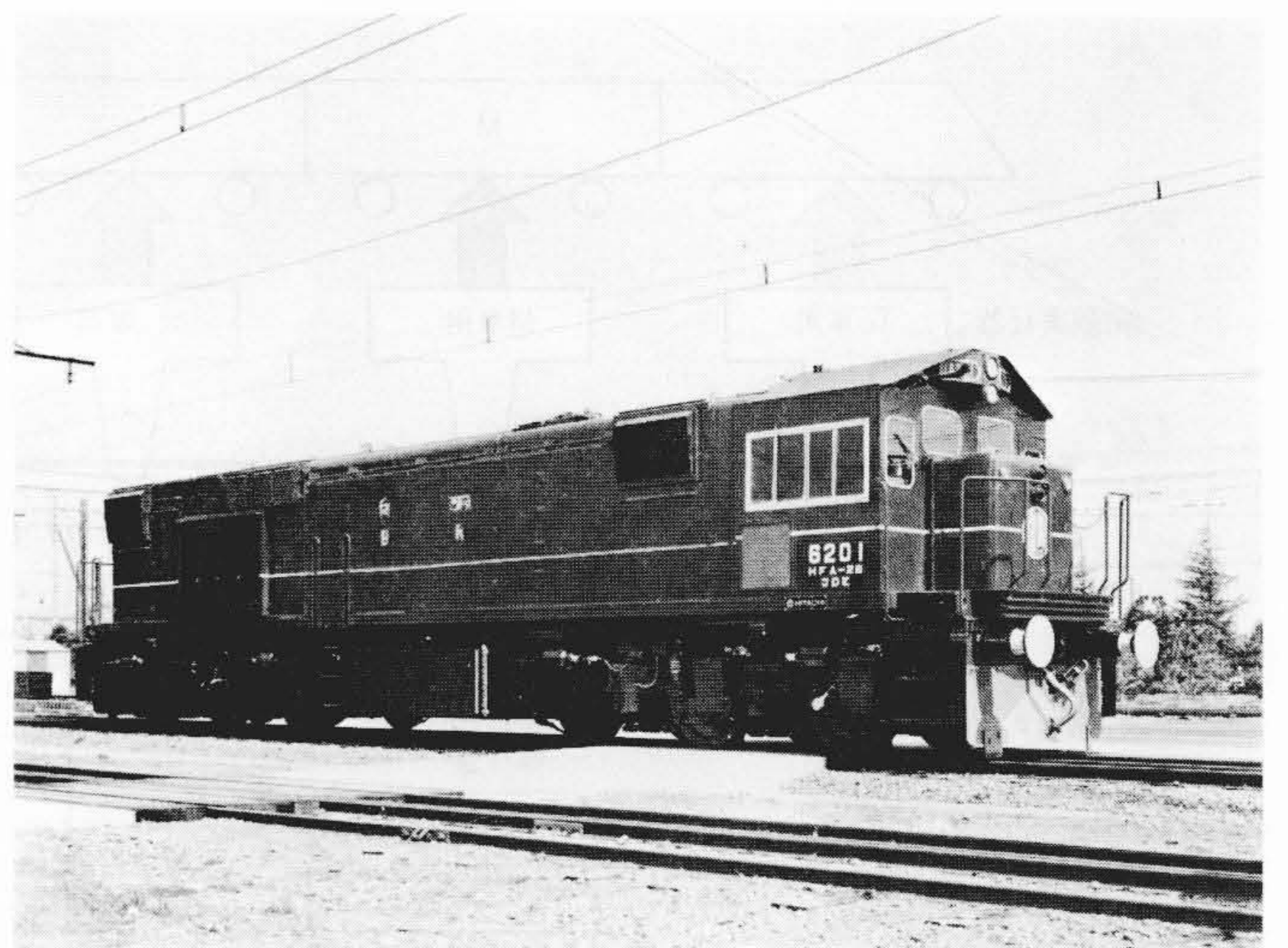
図11 バングラデシュ国有鉄道納め交流式ディーゼル電気機関車 バングラデシュ国有鉄道広軌用として製作されたエンジン出力2,450HP、総重量112tの大形交流式ディーゼル電気機関車を示す。
