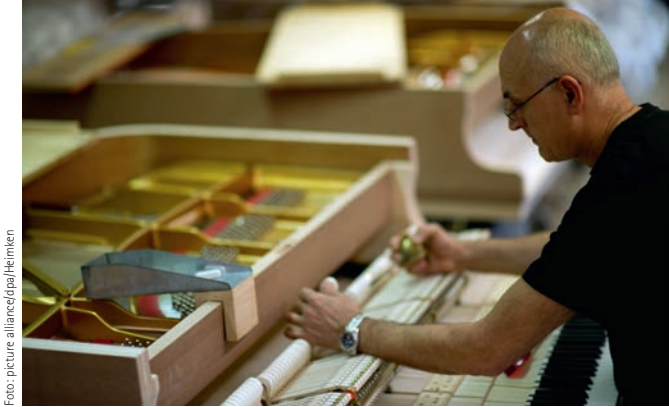
Fertigung des Hammerwerks für einen Konzertflügel bei Steinway
