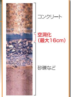
堰基礎下部の空洞化
