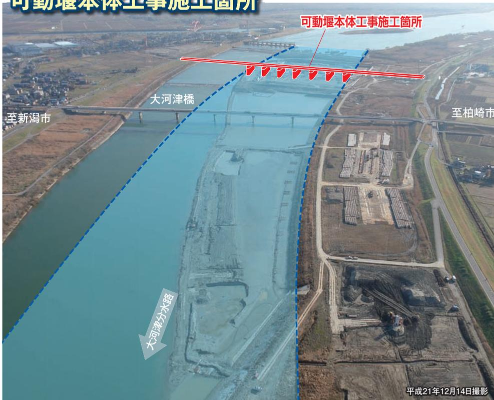
新可動堰は、現在の可動堰を機能させながらコストを軽減し、安全に工事ができるようにするため、現在の可動堰より400mほど下流の、河道中央 (現在高水敷) に建設されます。
