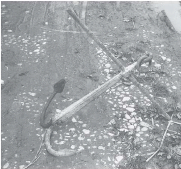
Abb. 72: Zweiarmiger Anker in Täuffelen (BE 30). Im Gegensatz zum vierarmigen Anker hat der zweiarmige eine Querstange. [Quelle: SDS]
