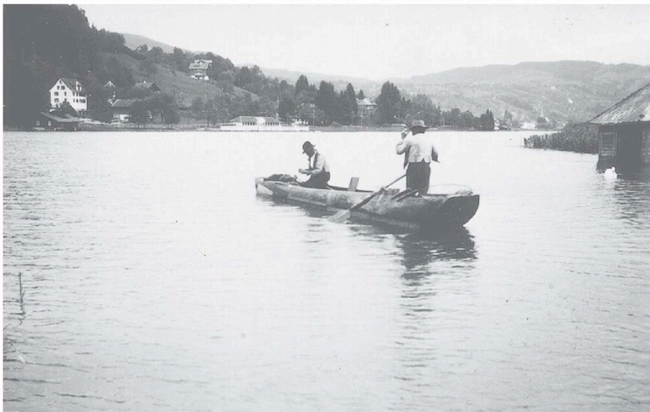
Abb. 51: Der echte Einbaum in Ägeri wird stehend gerudert. Hinten links befindet sich das Faarrueder, vorne rechts das Zieruederli. Befindet sich nur ein Fischer im Boot, wird nur mit dem Faarrueder gerudert. [Quelle:
