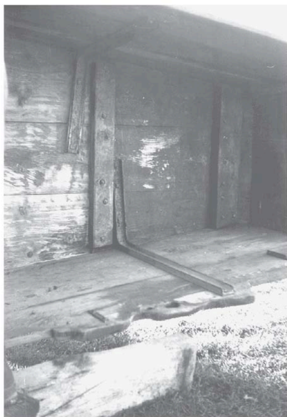
Abb. 41: Gürbe aus Eisen im Granse von Wollerau (SZ 1). Die Gürben reichen nur bis in die Mitte des Bootes. Die Bodenplanken werden zusätzlich durch Querhölzer zusammengehalten. [Quelle: SDS]
