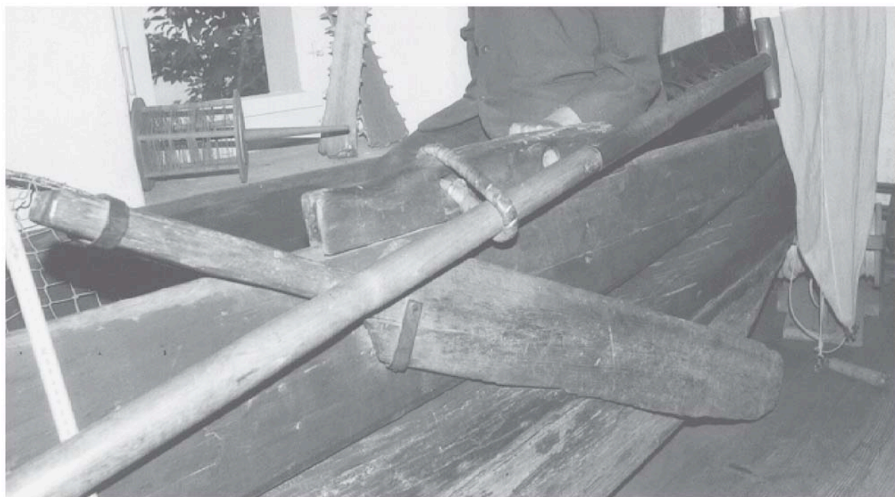
Abb. 57: Die Ruderbefestigung eines aufgestockten Einbaums im Fischereimuseum in Zug. Der Ring, durch den das Ruder gesteckt wird, ist aus Weidenruten gebildet. Hinter der Ruderstange des eigentlichen Ruders ist das an der Bordwand eingehängte Strichrueder zu sehen. [Quelle: Bickel]
