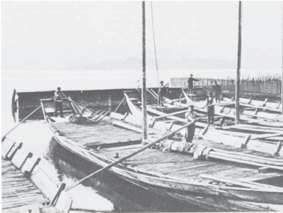
Abb. 55: Lastschiffe um 1900 in Obermeilen am Zürichsee. Im vorderen Teil des Schiffes rudert der Schiffsknecht, hinten der Meister mit dem Naafaarrueder. Die Ruder waren ca. 10 m lang. [Quelle: WELTI, HILDE (HRSG.). 1974. Ledischiffe auf dem Zürichsee. Stäfa: Th. Gut, S.75]
