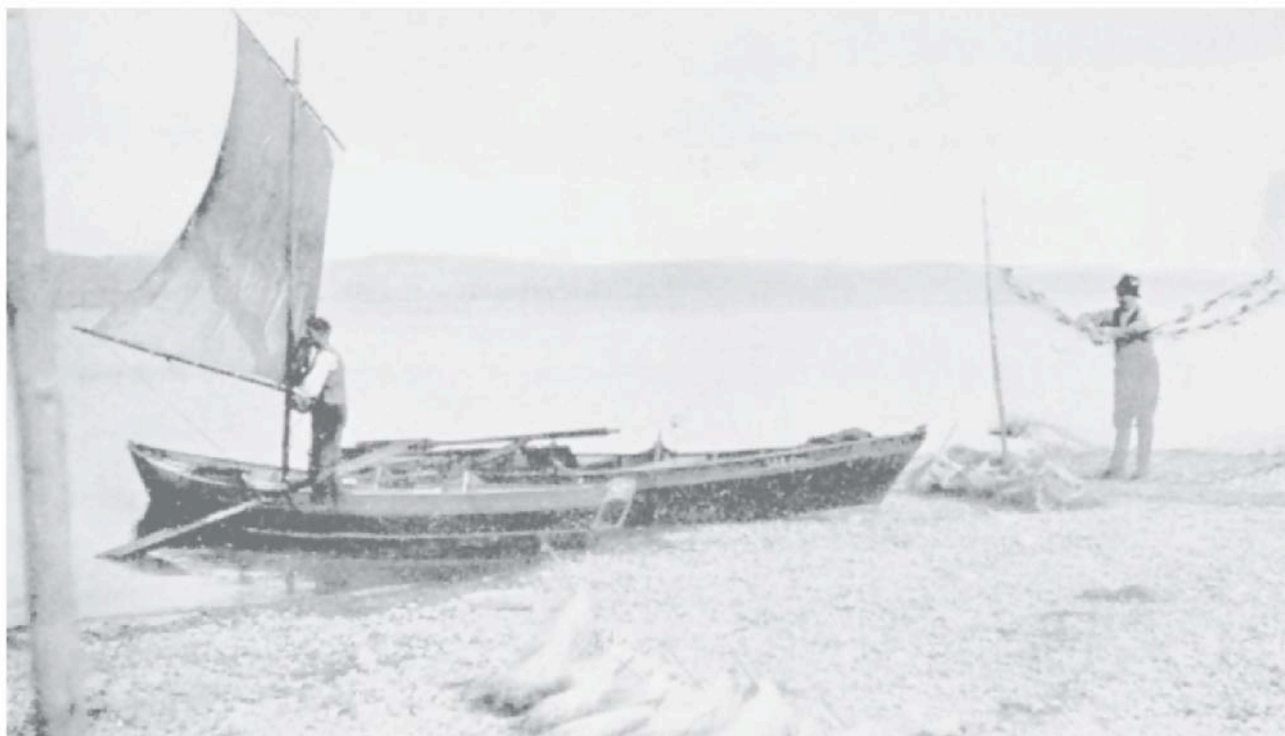
Abb. 67: Ein Fischer der Insel Reichenau im Bodensee setzt das Segel in der Gondle. Es handelt sich um ein Luggersegl. Segelantrieb auf Fischerbooten war nicht auf allen Seen der deutschen Schweiz üblich. [Quelle: MÖKING]
