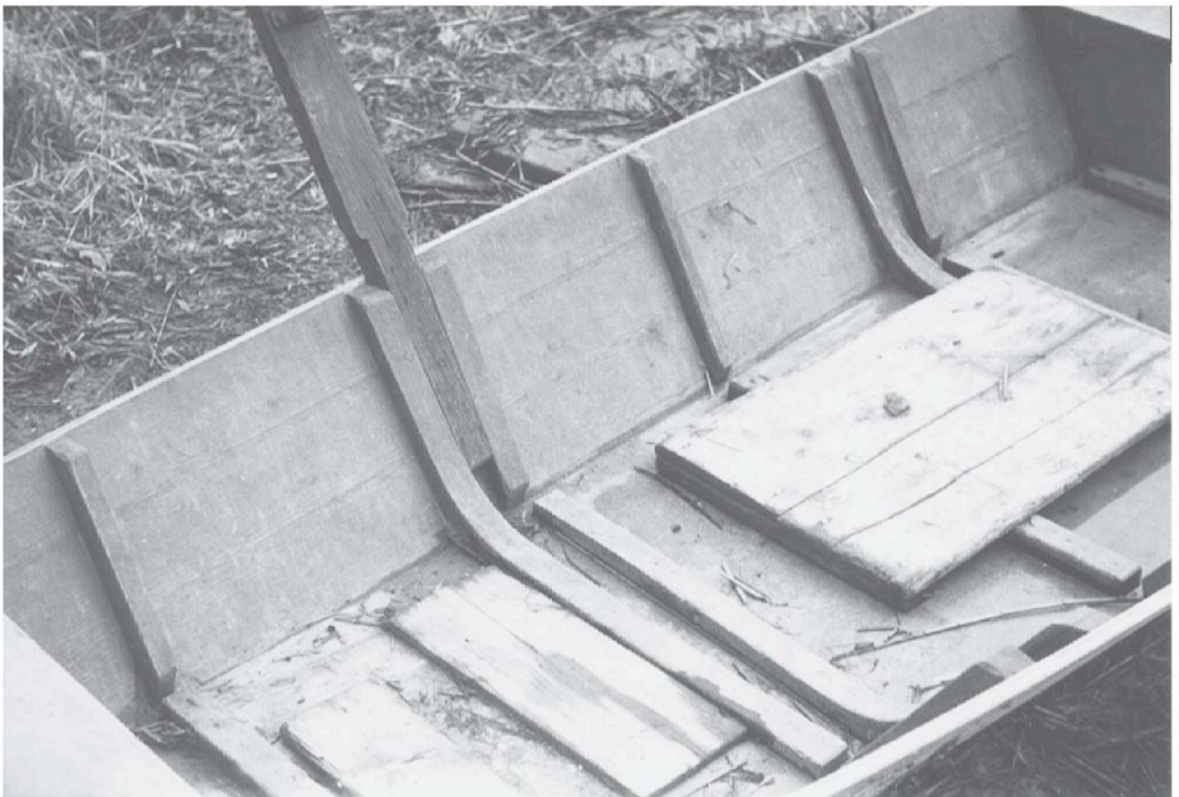
Abb. 42: Range aus Holz im Logettl von Muntelier (FR 1 F ). Neben den Range, die Boden- und Seitenplanken zusammenhalten, gibt es auch Querhölzer, die nur den Boden bzw. nur die Wand zusammenhalten. Diese werden ebenfalls Range genannt. [Quelle: SDS]
