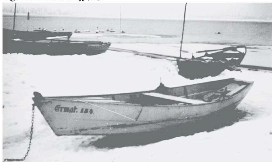
Abb. 113: Jagdschiffli in Ermatingen (TG 8). Obwohl es für den Einsatz auf Eis konzipiert ist, ist es gleich wie andere Boote gebaut. [Quelle: SDS]
