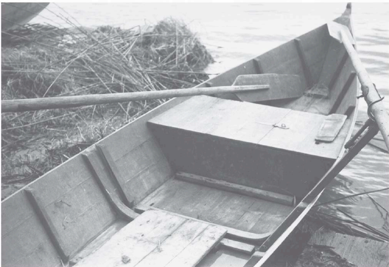
Abb. 39: Grängli nennt der Berufsfischer von Muntelier (FR 1 F ) den eingebauten Fischbehälter. Er ist im vorderen Teil des Bootes untergebracht, füllt jedoch nicht die ganze Spitze des Bootes aus. [Quelle: SDS]
