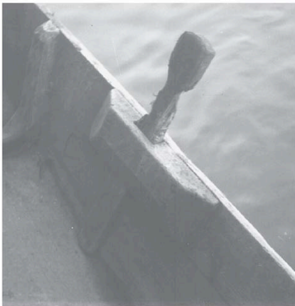
Abb. 56: Ein Stecklig im Weidlig von AG 29 (Brugg/Stilli). Er wird nur beim Übersetzen von einem Ufer zum andern gebraucht, sonst wird freihändig gerudert. [Quelle: SDS]
