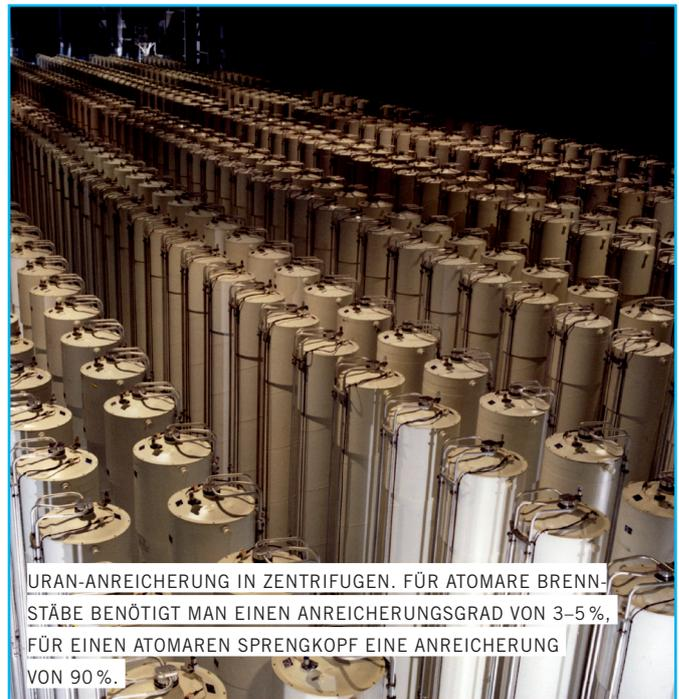
URAN-ANREICHERUNG IN ZENTRIFUGEN. FÜR ATOMARE BRENNSTÄBE BENÖTIGT MAN EINEN ANREICHERUNGSGRAD VON 3–5 %, FÜR EINEN ATOMAREN SPRENGKOPF EINE ANREICHERUNG VON 90 %.
