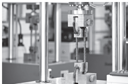
Dauerfestigkeits- und Zeitfestigkeitsüberprüfungen durch mehr als 15 Pulsatoren nach unterschiedlichen Prüfverfahren
