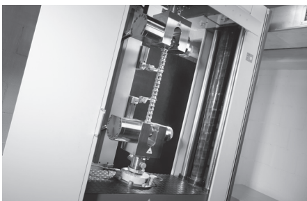
Bruchkraftermittlung und Dehnungsaufnahmen bis 1000 kN
