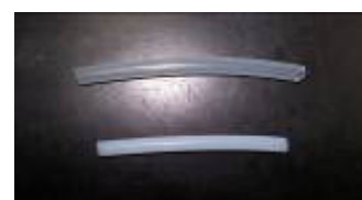
上：シリコン製導管 下：テフロン製導管
