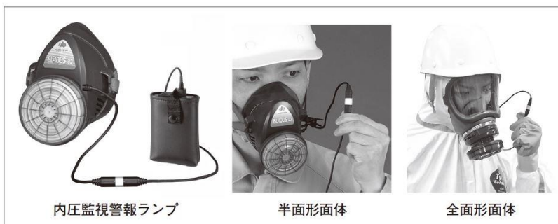
図3 電動ファン付き呼吸用保護具 使用中に送風の減少が原因となる面体内圧の低下をランプの点滅で警報する『内圧監視警報機能』を搭載したモデル
