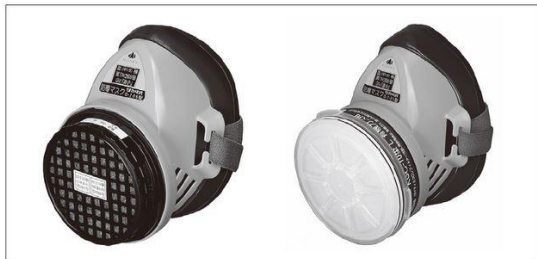
図2 防毒マスク 発生するガスにあわせて吸収缶の種類を選定する （右：粉じんが混在する場合のフィルター取付け時）
