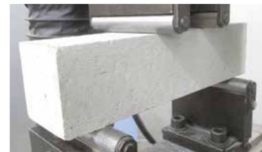
コンクリート供試体の曲げ試験
