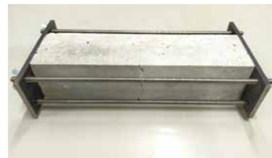
コンクリート供試体のひび割れ幅を0.2 mm程度に固定
