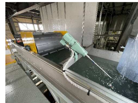
廃プラスチックの水槽式比重選別機
