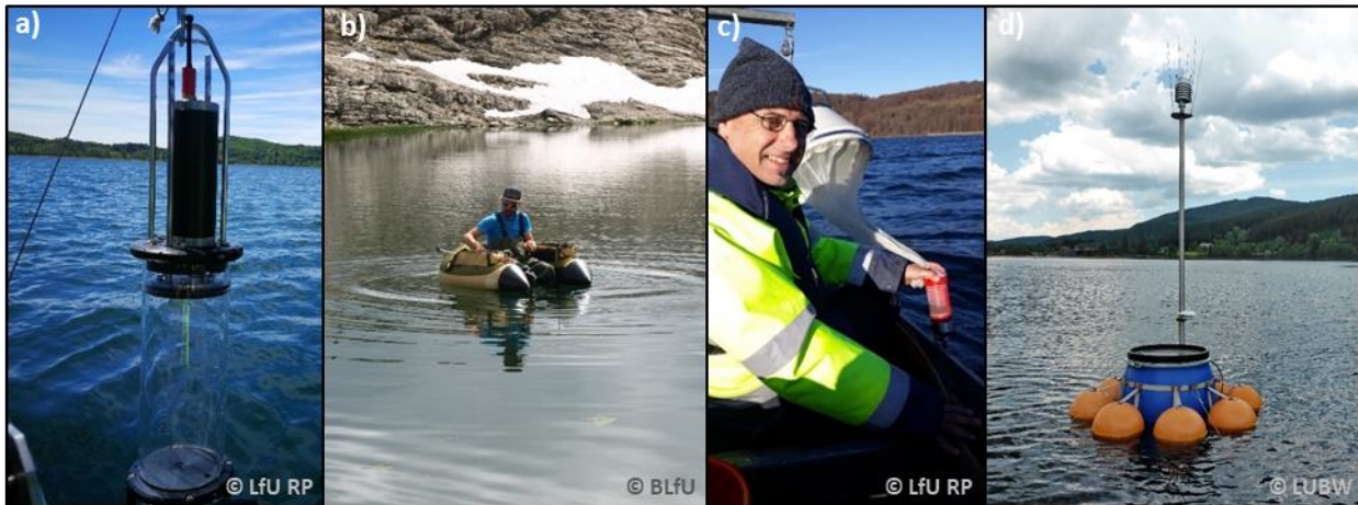
Abb. 51: Monitoringaktivitäten in Seen: a) Integrierender Schöpfer zur Chemie- und Phytoplanktonprobenahme, b) Probenahme mit Bellyboot (Laufbichlsee), c) Zooplankton-Beprobung (Laacher See), d) Messboje mit Datenloggern im Tiefenprofil und Meteorologiemessaufbau im Einsatz (Titisee).
