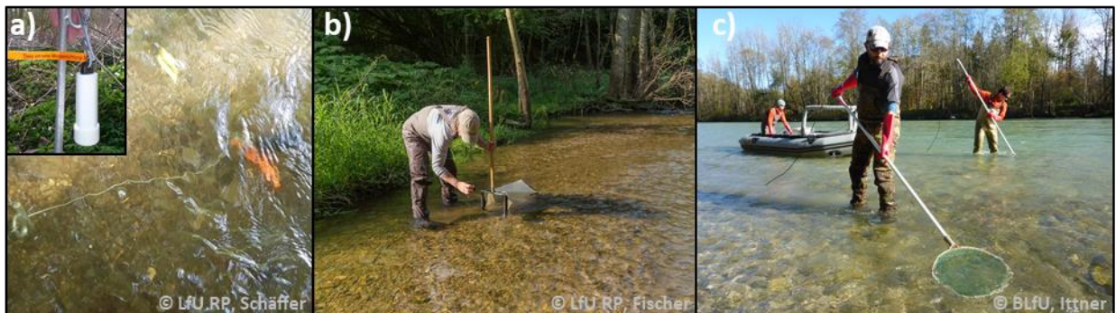
Abb. 50: Monitoringaktivitäten in Fließgewässern: a) Wassertemperatur-Datenlogger, b) Beprobung der aquatischen Wirbellosen (Makrozoobenthos), c) Untersuchung der Fischfauna (Elektrofischung).
