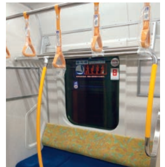
▲優先席、低い吊り手、低い荷棚、つかまりやすい縦の手すり
