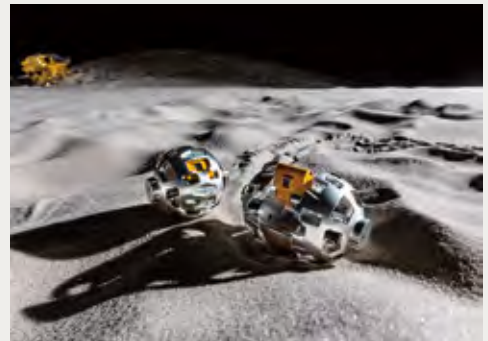
SORA-Qが球体から走行モードへ変形 ©JAXA/タカラトミー/ソニーグループ機/同志社大学
