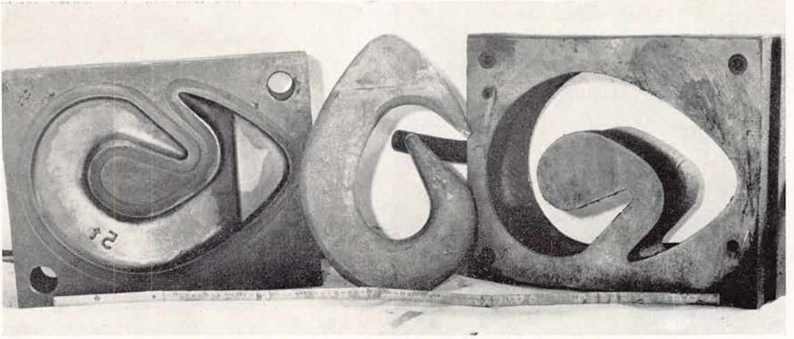
Ladehaken-Gesenkhälfte mit Abgrater und Haken
