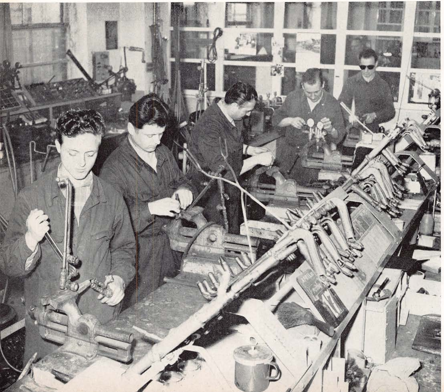
Unsere Mechaniker bei der Reparatur von Schneid- und Schweißgeräten
