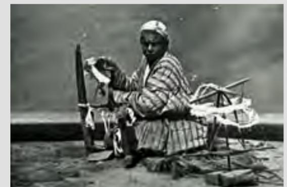
снимке альбома «Шелковое производство. Приготовление берд на горизонтальном станке» (илл. 5) мастер делает узкое бердо для традиционно узких тканей. На фотографии показан горизонтальный станок для приготовления берд простейшей конструкции. Он состоит из деревянной пластины с вертикально поставленными колышками, между которыми натянута нить. За работой мужчина в полосатой рубахе с круглым вырезом и тубетейке.
