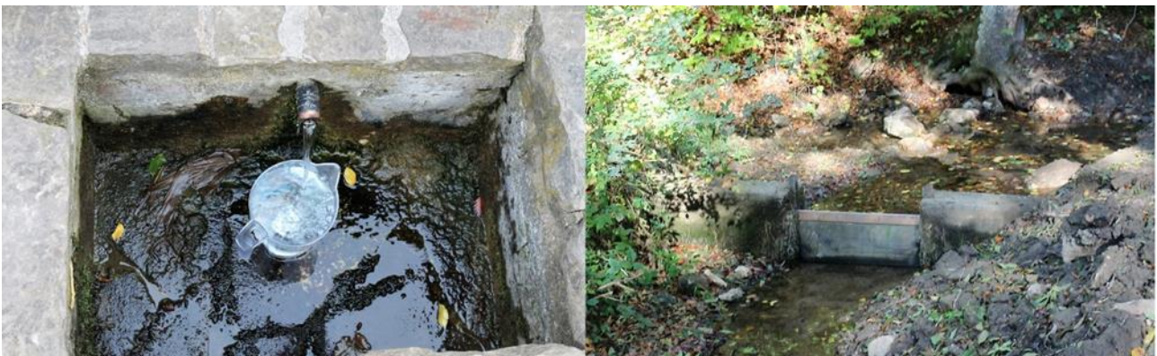
Abbildung 4-17: Schüttungsmessung als Gefäßmessung an der Aldericusquelle (010409415) (links) bzw. als Abflussmessung über einen Überlauf (Wehr) an der Schalkseifenquelle (010409609) (rechts).
