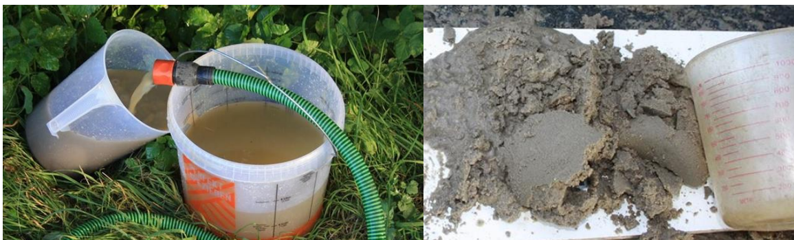
Abbildung 4-22: Färbung und Trübung während des Demonstrativpumpversuchs unverändert, Zunahme der Sedimentführung und der Auflandung am Beispiel der Messstelle IV/10 Emsdetten (110040107)
