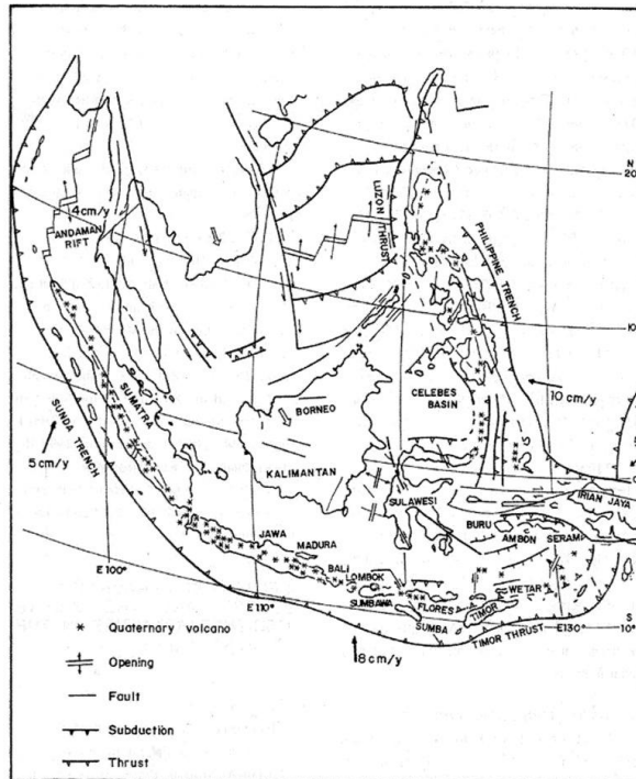
Gambar 7. Peta Skematik Kerangka Geotektonik Indonesia dan sekitarnya (Kompilasi dari Nishimura (1990), Tapponier (1992)).
