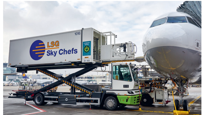
Der vollelektrifizierte Catering-Hubwagen „eLift“ ist bei der LSG Group in Frankfurt im Einsatz.
