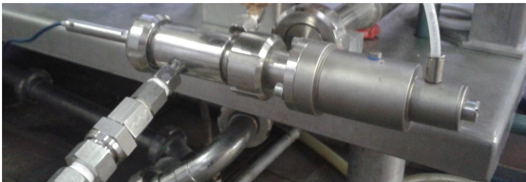
Abb.: 25 Dampfinjektor (Bauart Tetra Pak) mit Druckhalteventil für die Punkt-Erhitzung von Milch. Dr. C. Kiesner, MRI Kiel.
