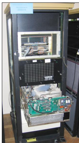
Foto 23. Convex Supercomputer, Unitate centrală, seria 00125B, Convex Computer U.S.A. (HP), 1989. Sistem de operare UNIX
