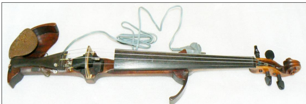
Foto 21. Vioara electromagnetă fără cutie de rezonanță brevetată de ing. Gabriel Dimitriu
