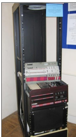
Foto 22. Unitate centrală originală, seria 01:05671, produsă de Digital Equipment Corporation, 1971. Sistem de operare RSX11 – varianta UNIX
