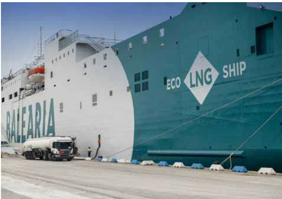
Bunkering LNG from a road tanker.
