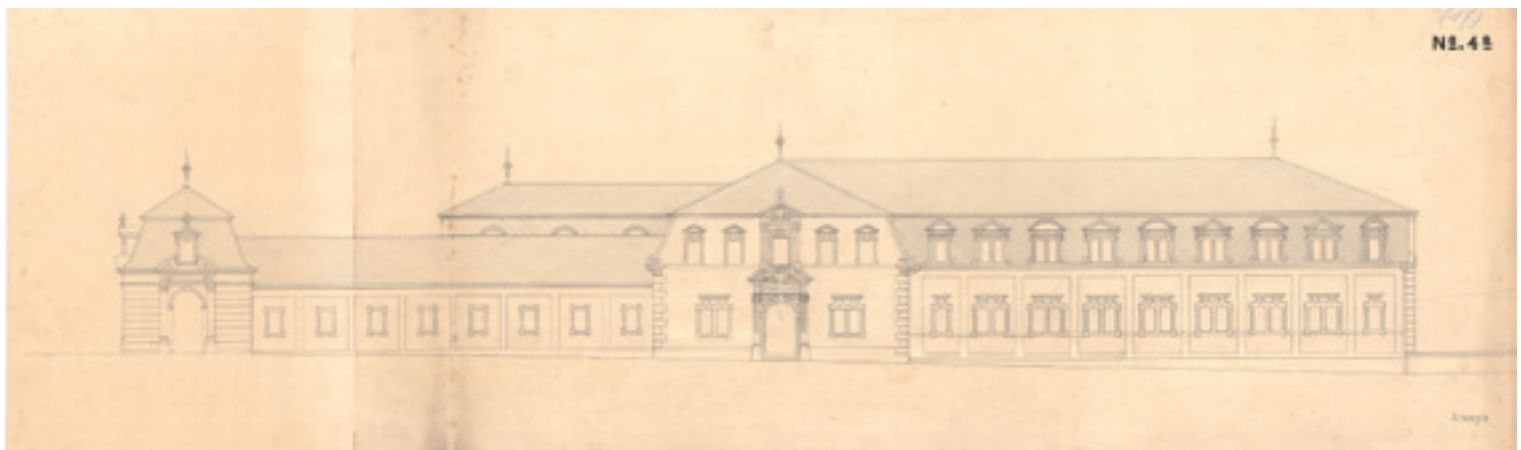
Insbesondere in Hinblick auf den ungenutzten Stauraum des Dachbodens legte Walther einen Alternativentwurf mit einem niedrigeren Mansardendach vor. Die barocke Fassadengestaltung steht in Kontrast zu dem von Walther kultivierten „Nürnberger Stil“, Plan 1877. (StadtAN A4/II Nr. 3 GF)
