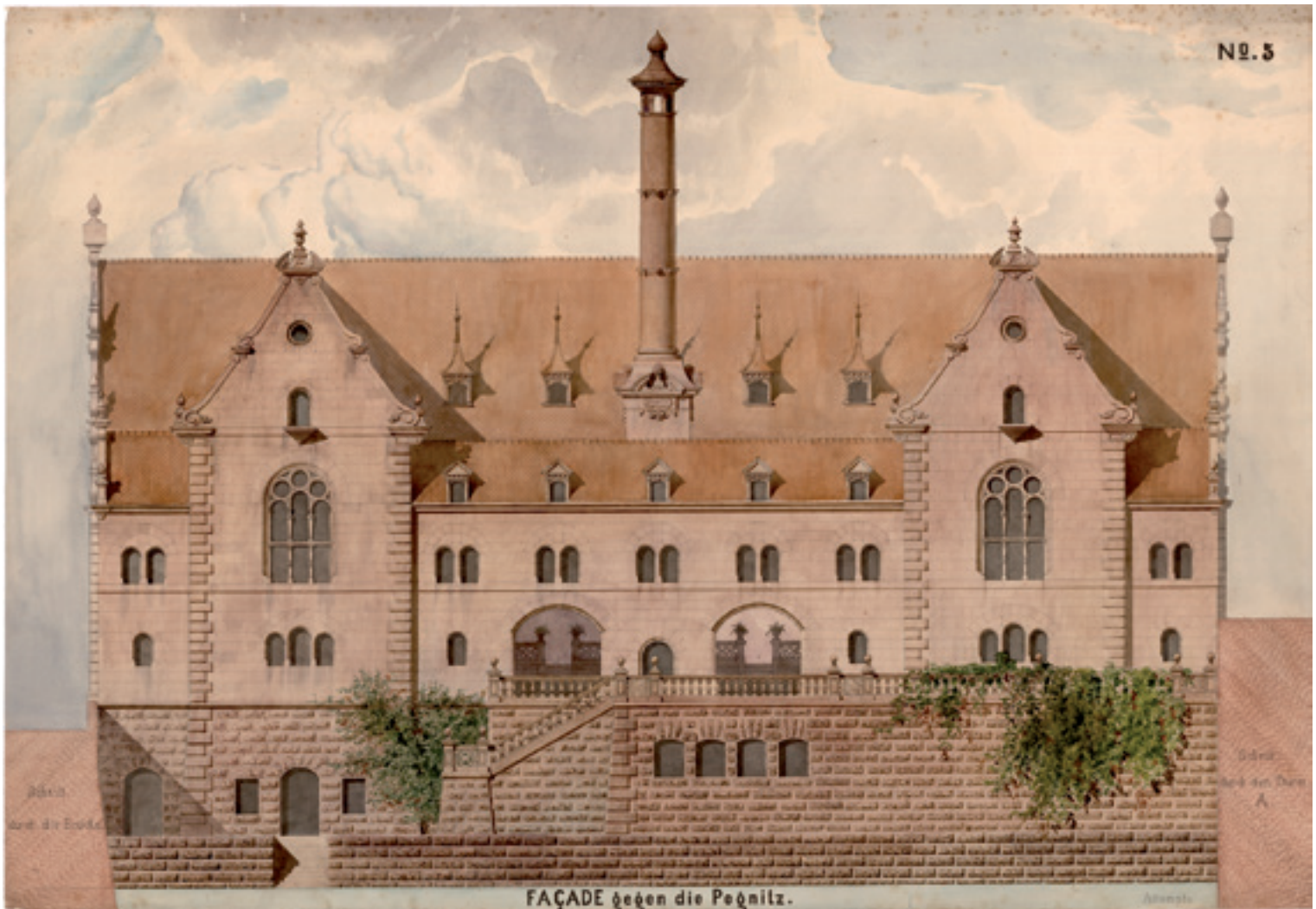
Die Pegnitzpartie gestalteten Freitreppe und Terrasse. Die riesige Fläche des steilen Satteldachs brachte nicht nur Mehrkosten an Zimmerer- und Dachdeckerarbeiten, wie Walther selbstkritisch einräumte, sondern für den Badebetrieb nicht nutzbare Platzreserven. Etwas improvisiert wirkt hier seine Empfehlung, den Raumüberhang als Hopfenlagerplätze und Trockenräume zu vermieten, Plan 1877. (StadtAN A4/II Nr. 3 GF)
