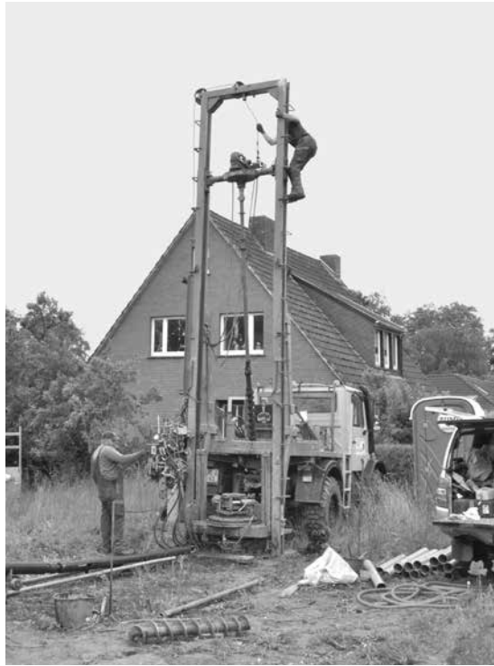
Entnahme von Bohrkernen auf der Dorfwurt von Oldersum. Mit einer vergleichbaren Technik wurden auch in Emden und Borssum Bohrkernge gezogen (Foto: Ines Reese, Ostfriesische Landschaft).
