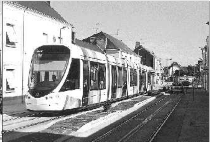
Mehr als konsequent: entweder Einfachfahrleitung oder gar das aufwendige Stromschienensystem wie in Angers.
