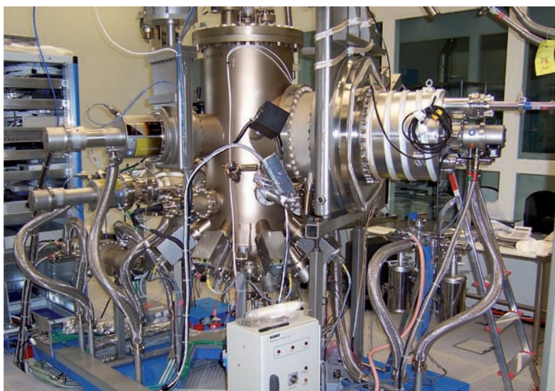
Bild 4: Molekularstrahl-Epitaxie-Anlage (MBE) der PTB zur Herstellung von GaAs-Schichtkristallen für Quanten-Hall-Widerstände
