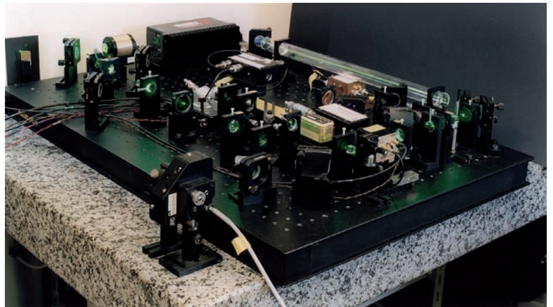
Bild 11: I_2 -stabilisierter, frequenzverdoppelter Nd:YAG-Laser
