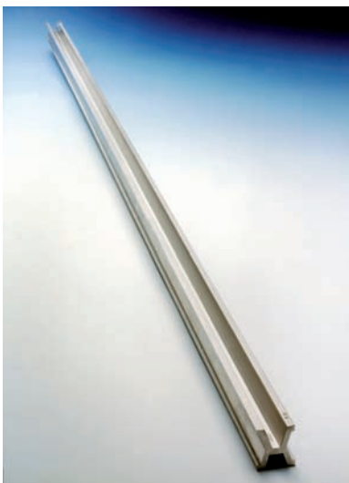
Bild 6: Internationaler Meter-Prototyp, ein Strichmaßstab mit X-förmigem Querschnittsprofil aus Platin-Iridium.
