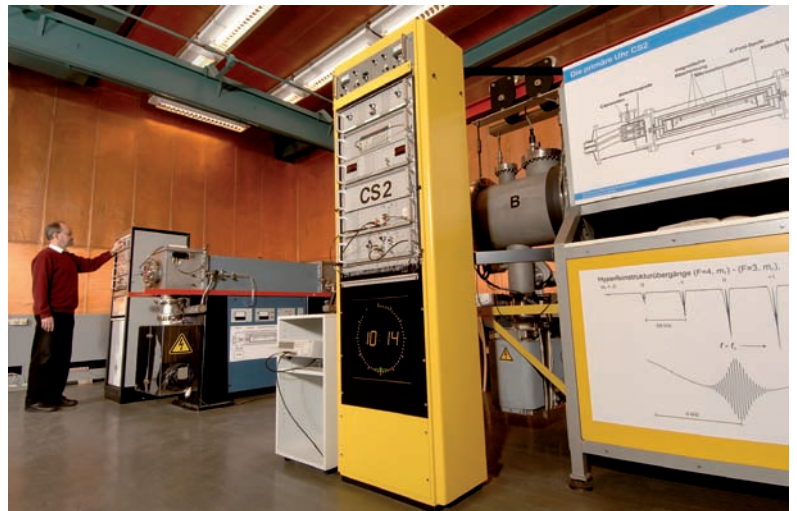
Bild 6: Ansicht der primären Uhren CS1 und CS2 der PTB.
