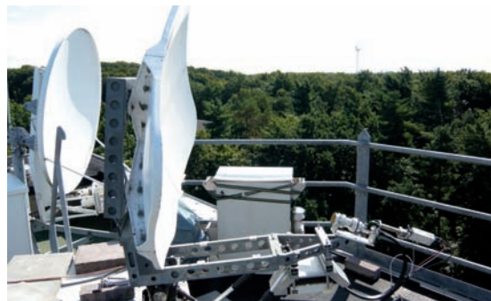
Bild 12: Aufbau eines transportablen Satellitenterminals zur Kalibrierung der Zeitvergleiche über TWSTFT mit der stationären Anlage (Hintergrund).
