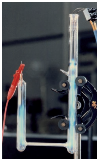
Bild 7: Kryptonlampe nach Engelhard zur Darstellung der Längeneinheit 1960–1983.
