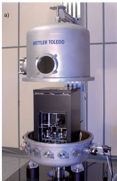
Bild 3: Prototypwaagen der PTB (1-kg-Vakuum-Massekomparatoren, aufgestellt in vakuumfesten Kammern):
