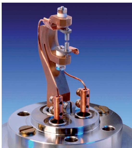
Bild 14: oben: Vakuumrezipient mit Ionenfalle (im Zentrum) für die Spektroskopie einzelner Ytterbium-Ionen [41], unten: Detail der neuesten Fallenanordnung, einer sogenannten Endkappenfalle, die seit Anfang 2010 benutzt wird.
