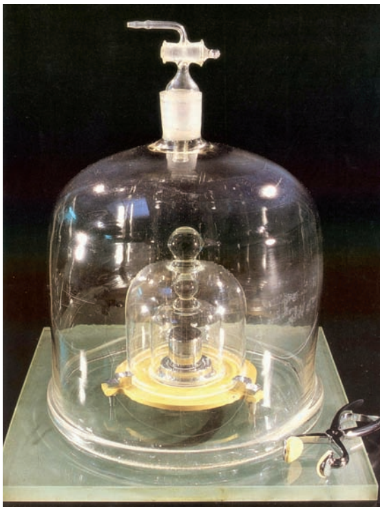
Bild 1: Internationales Kilogrammprototyp (aufbewahrt unter drei Glasglocken im Internationalen Büro für Maß und Gewicht (BIPM) in Sèvres bei Paris)
