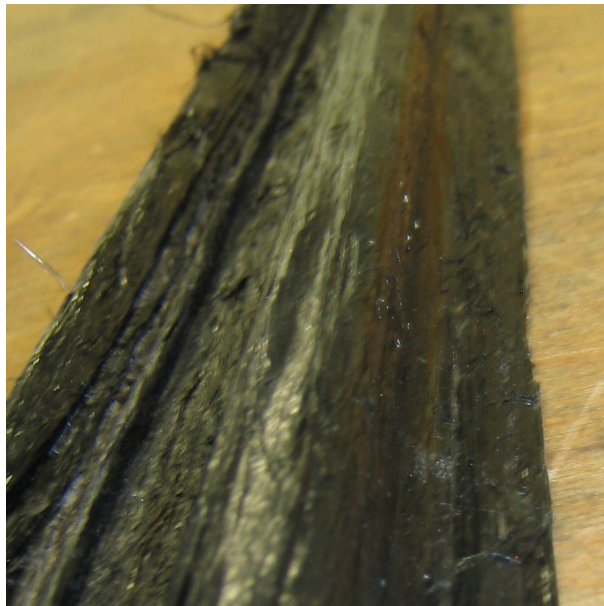
Abbildung 10-1: Foto des Profils des ersten Testlaufs: deutlich erkennbar die ungenügende Oberflächenqualität durch das Matrixhaften
