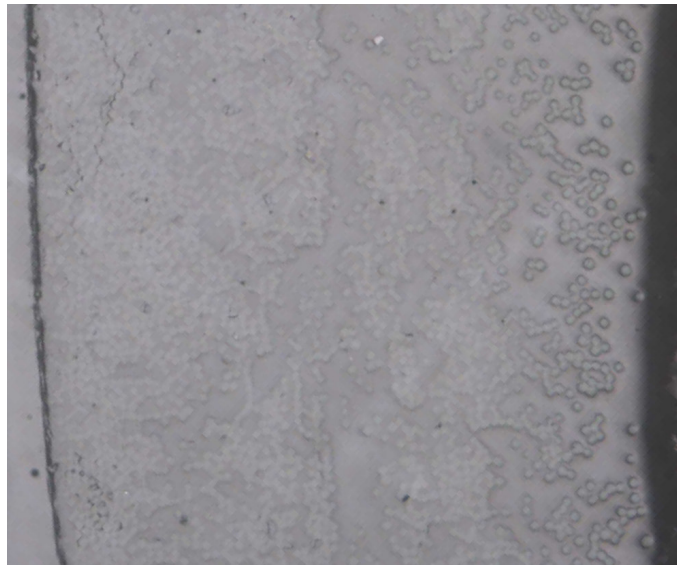
Abbildung 10-9: Schliffbildaufnahme des Mittelstücks, aufgenommen mit 5-facher Vergrößerung. Die Trennebene ist noch schwach als matrixreicherer Streifen erkennbar. Die rechte Seite entspricht der Profilinnenfläche, die Wandstärke beträgt ca. 1 mm.
