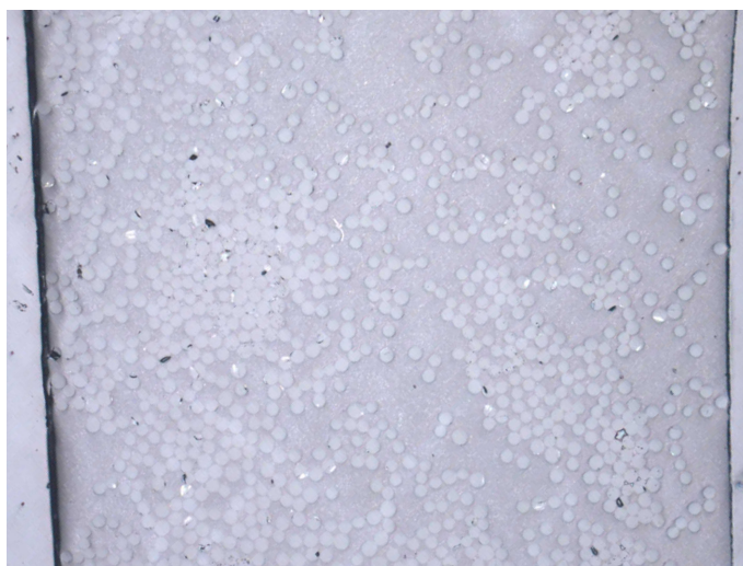
Abbildung 10-8: Schliffbildaufnahme der Flanke, 10-fache Vergrößerung. Die rechte Seite entspricht der Profillinienfläche.
