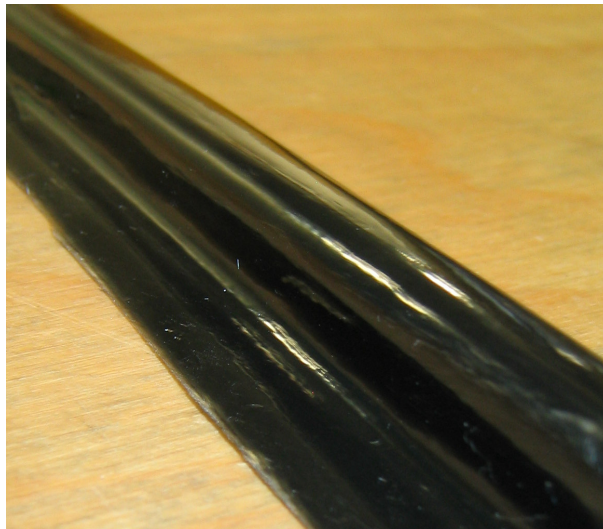
Abbildung 10-3: Foto eines Profils hergestellt mit Kapton-Trennfolie. Die glänzende, gut Verschlussene Oberfläche zeugt von guter Qualität.
