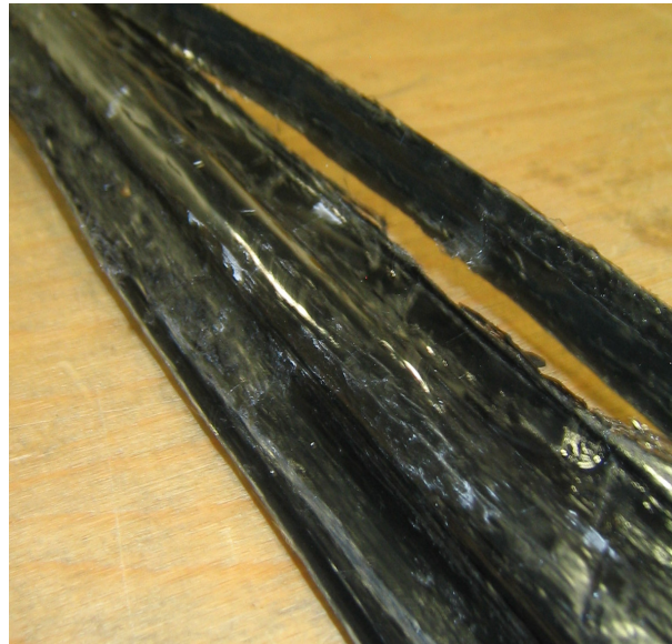
Abbildung 10-2: Foto eines Profils das mit PET-Trennfolie hergestellt wurde. Die schlechte Oberflächenqualität ist gut erkennbar, vereinzelt haften noch Folienreste am Profil. Rechts oben ist das Resultat der Bandverschiebung sichtbar, die Rollenflanken haben das Material abgetrennt.
