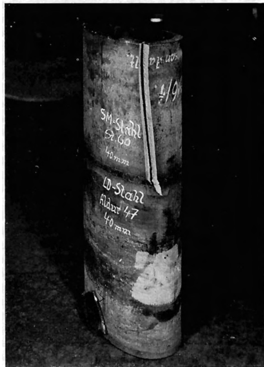
Bild 3: Biegeversuch mit einem halben Rohrschuß, Durchmesser 1200 mm, zusammengeschweißt aus einem LD-Baustahlblech Aldur 47 von 40 mm Dicke (52 kg/mm 2 Zugfestigkeit) und einem sprödbrechempfindlichen SM-Stahlblech St 60. Der beim Biegeversuch eingetretene plötzliche Bruch wurde hart an der Schweißnaht vom LD-Stahlblech abgefangen.
