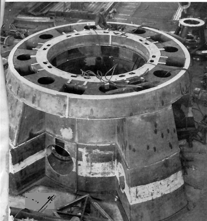
Geschweißtes Tur- binengehäuse einer vierdüsigen Frei- strahltriebchine für das Kraftwerk Lünersee der Vorarlberger Illwerke A. G.
