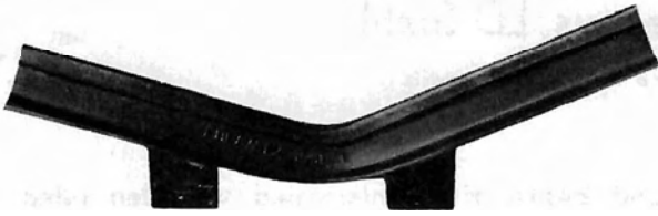
Bild 4: Schienenschlagversuch, Schlagarbeit: 20 mt, Pfeilhöhen: 184 und 206 mm
