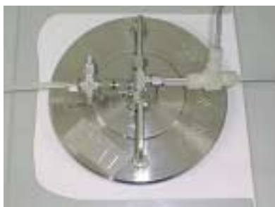
Emissionsmesszelle. Auf den getrockneten Anstrich gedrückt lassen sich flüchtige organische Verbindungen damit bestimmen.
