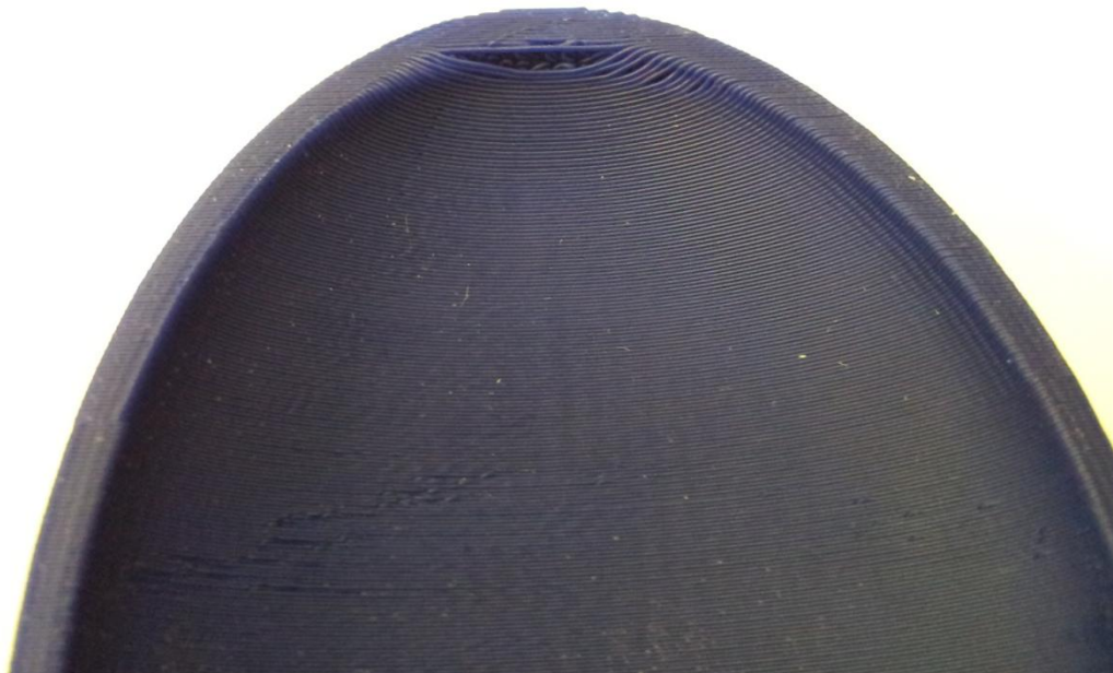
Kuva 30. Tulostustarkkuus ei riittänyt koveran puolen kärjelle.
