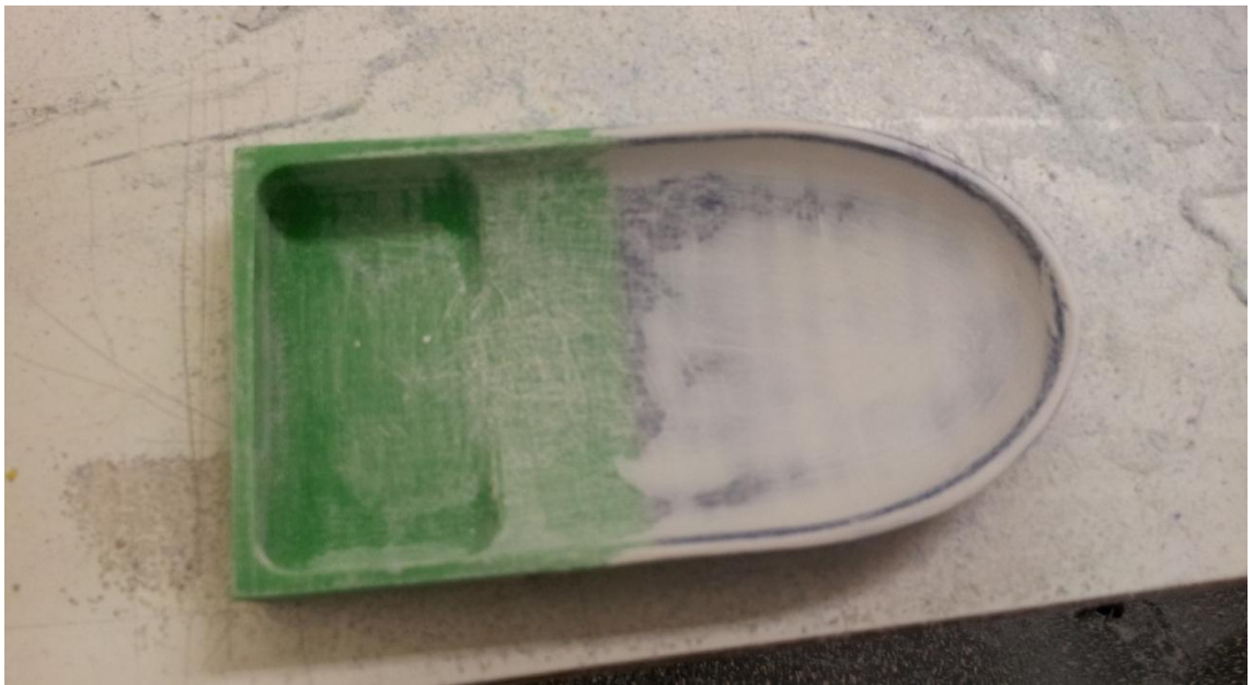
Kuva 32. Paklattu testikappale hionnassa.
