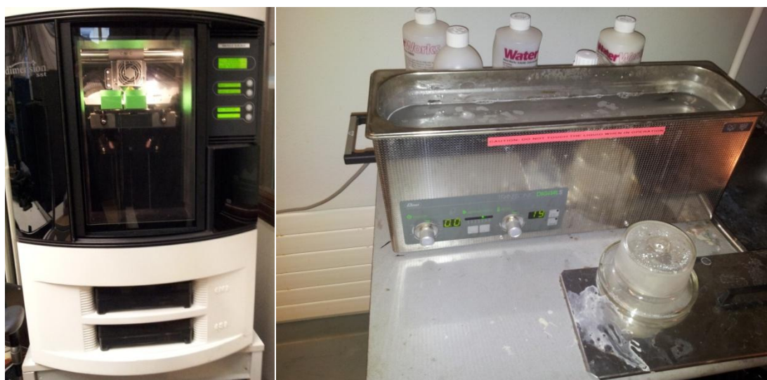
Kuva 28. 3D-tulostin tulostamassa testikappaleita (vasemmalla) ja ultraäänipesuri (oikealla).
