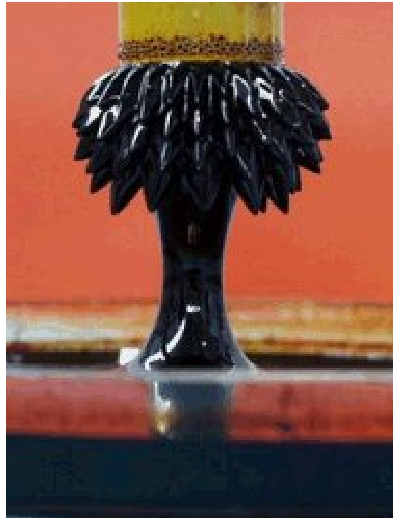
Abbildung 6 Ferrofluid unter Einfluss eines magnetischen Feldes.
