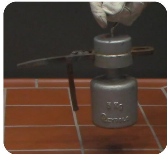
Abbildung 49: Durch Thermoelektrizität induziertes Magnetfeld; eigenes Bild; Material zur Verfügung gestellt von der TU Graz
