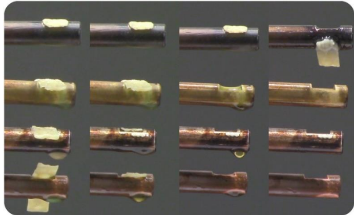
Abbildung 54: Wärmeleitungsverlauf verschiedener Metalle; eigenes Bild; Konzeption des Aufbaus von Ao.Univ.-Prof. Dipl.-Ing. Dr. techn. Gernot Pottlacher; zur Verfügung gestellt von der TU Graz
