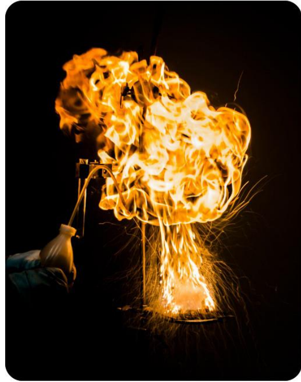
Abbildung 29: Fettbrand mit Wasser löschen; eigenes Bild; Material zur Verfügung gestellt von der TU Graz
