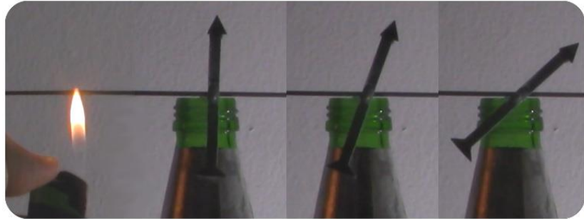
Abbildung 26: Längenexpansion eines Metallstabes; eigenes Bild; Material zur Verfügung gestellt von der TU Graz
