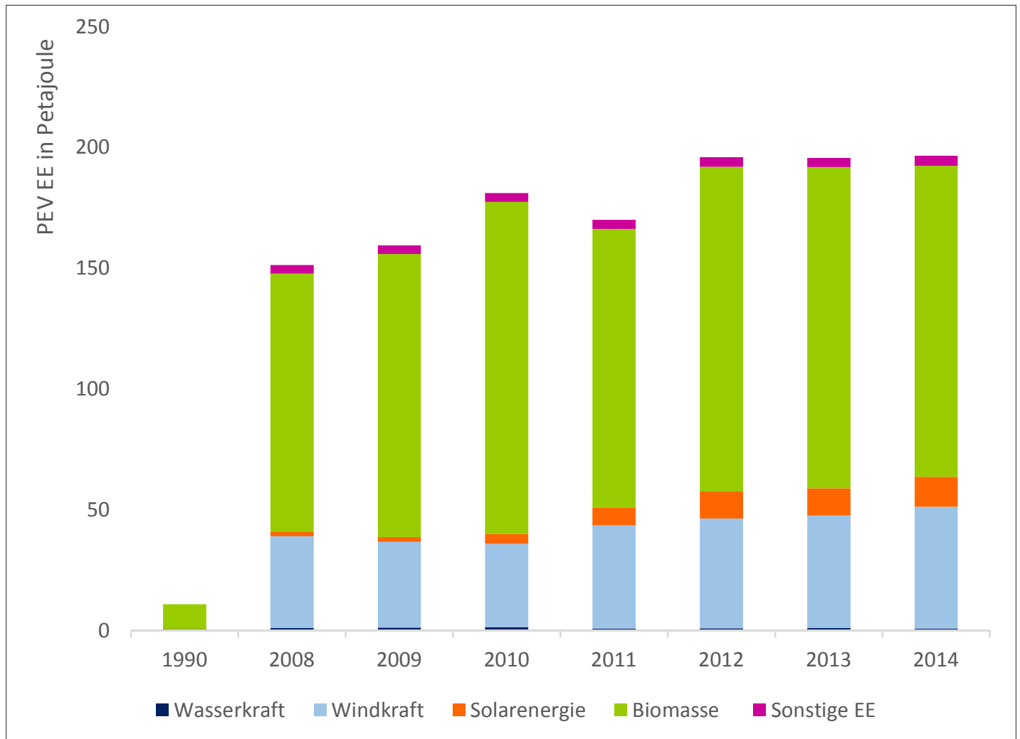
Abbildung 8: Entwicklung des Primärenergieverbrauchs von erneuerbaren Energieträgern in Niedersachsen gegenüber 1990 Quelle: LSN
