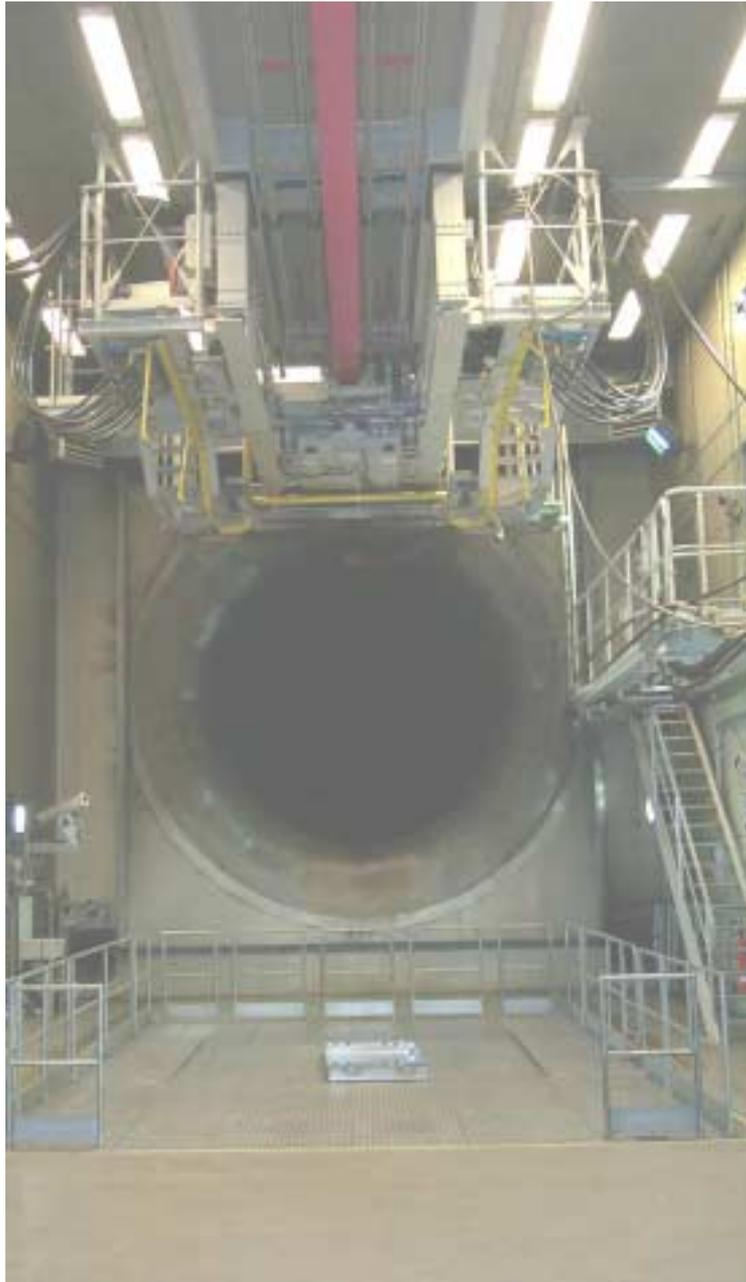
Abbildung 5: Kohlendioxid – Löschanlage eines Triebwerkprüfstands <sup>4</sup>
