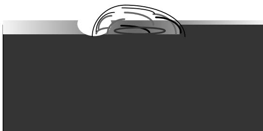
Durch Strömung und Kolkung Einsinken der Algenpakete
