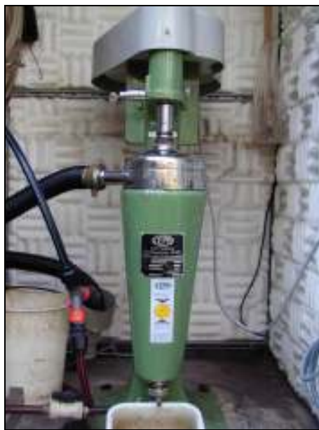
Foto 4.2: Durchflusszentrifuge Padberg Z61 (montiert auf Anhänger zur mobilen Beprobung; Foto: W. Rätz, BfG, 2005)
