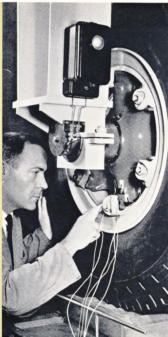
Die robusten TRILEX-Räder werden laufend im Labor auf Festigkeit und Dauerbelastung getestet.
