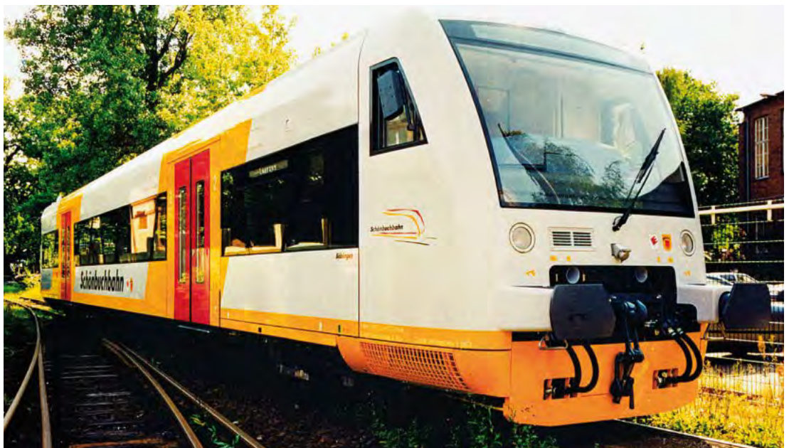
RegioShuttle (StadlerRail) – ein dieselbetriebenes Schienenfahrzeug: Alle äußerlich sichtbaren Elemente (Dachsegmente, Außenhautpaneele, Bugmaske, Scheiben) mit Ausnahme der Puffer und des Fahrwerks sind mit feuchtigkeitshärtendem 1K – Polyurethan-Klebstoff geklebt
