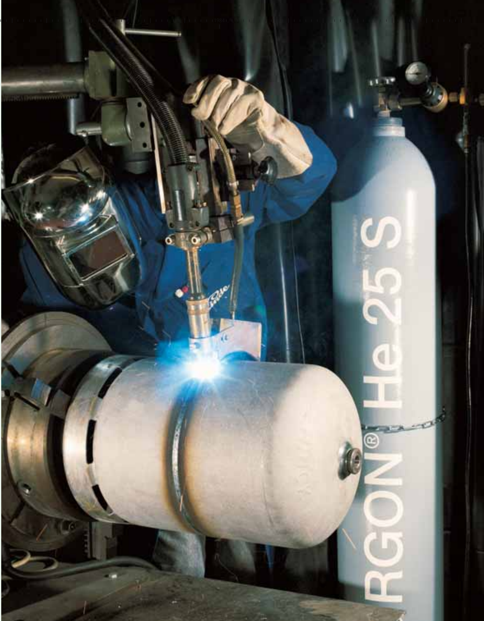
Schweißen mit dem Schutzgas „Corgon“ von Linde.
