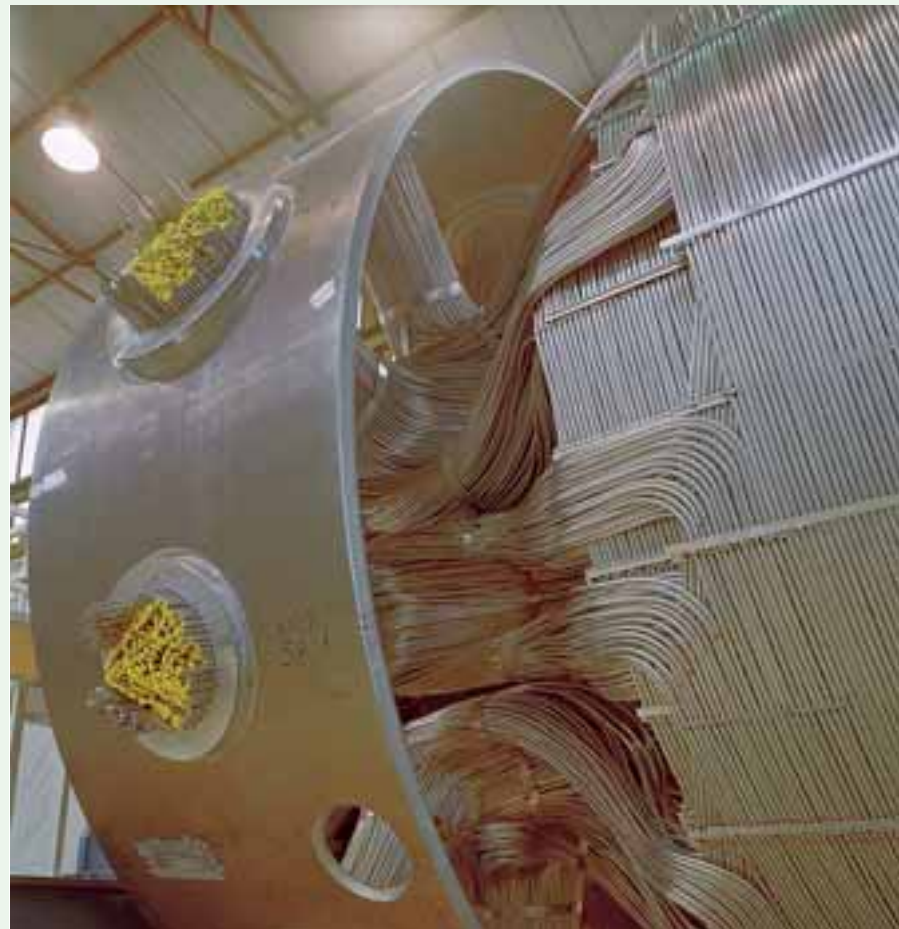
Eine Schlüsselkomponente in Erdgasanlagen: gewickelte Wärmetauscher.
