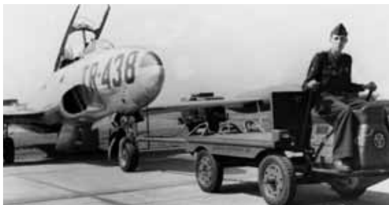
Ein Güldner-Hydrocar schleppt ein Flugzeug der Luftwaffe. Diese Fahrzeuge wurden etwa von 1958 bis 1965 in Aschaffenburg gebaut.
