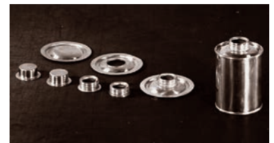
Fertigung von Ölkannenschraubverschlüssen aus LD-Stahl.
