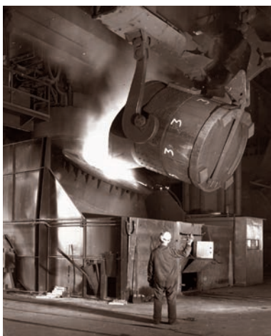
Einfüllen von Roheisen in einen 50-Tonnen-LD-Tiegel im LD-Stahlwerk 2 am Standort Linz.
