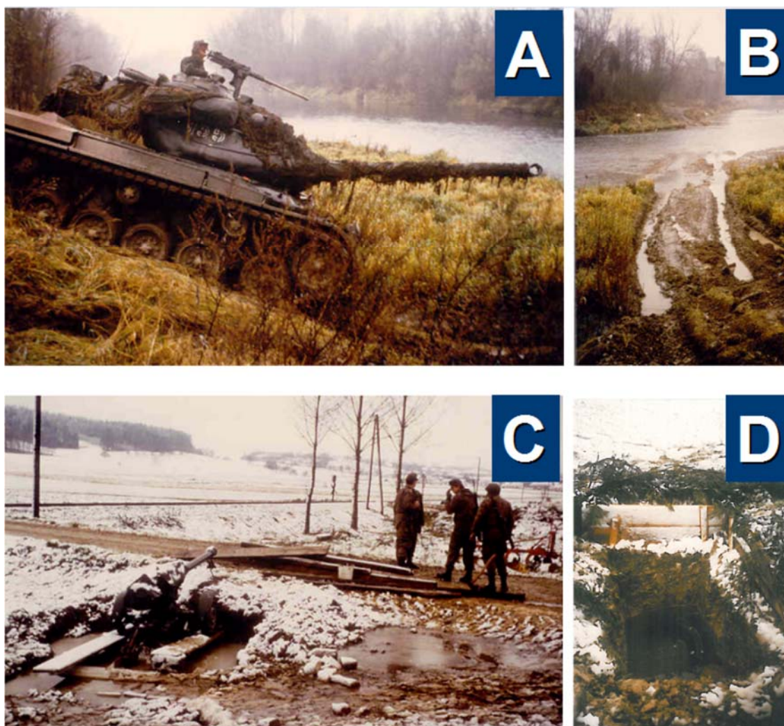
Abb. 5: Kampfpanzer M 60-A1 vor den Furten der Erlauf südlich Kendl (A). Ein Anlanden gepanzerter Fahrzeuge am durchnässten Ufer der hier noch Niederwasser führenden(!) Erlauf war ohne technische Hilfsmittel kaum möglich (Aufsitzen der Wanne; B). In den Tagwasser-vergleyten Böden konnten weder Stellungen der rückstoßfreien Panzerabwehrkanone (C) noch Schützenstellungen wirksam angelegt werden (D). Alle Aufnahmen vom Autor, 19.11.1979 bis 20.11.1979.
