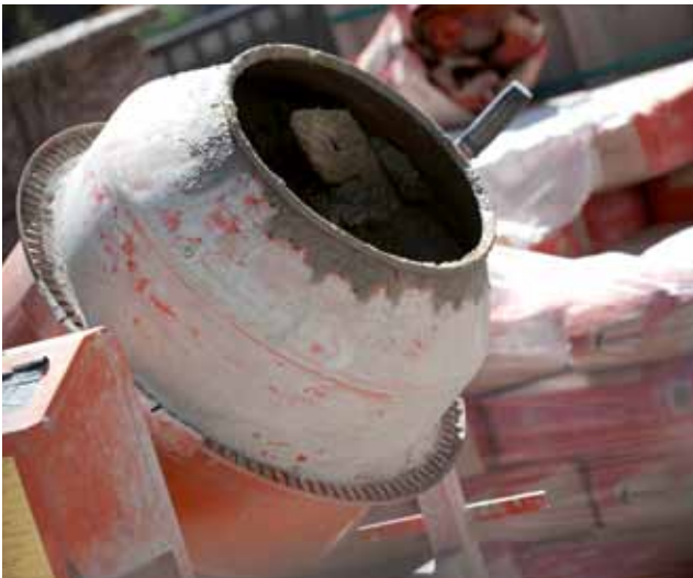
Abb. 10: Freifallmischer für kleine Betonmengen
