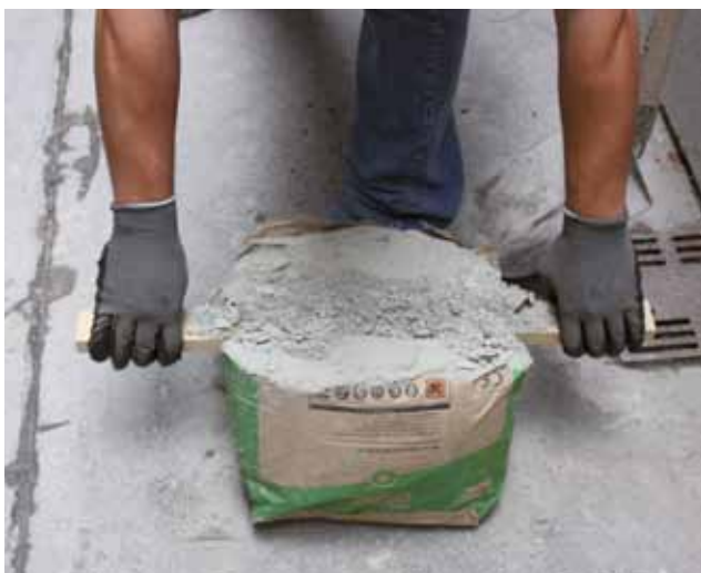
Abb. 13: Sackteilung durch Schaufel- oder Messerschnitt
