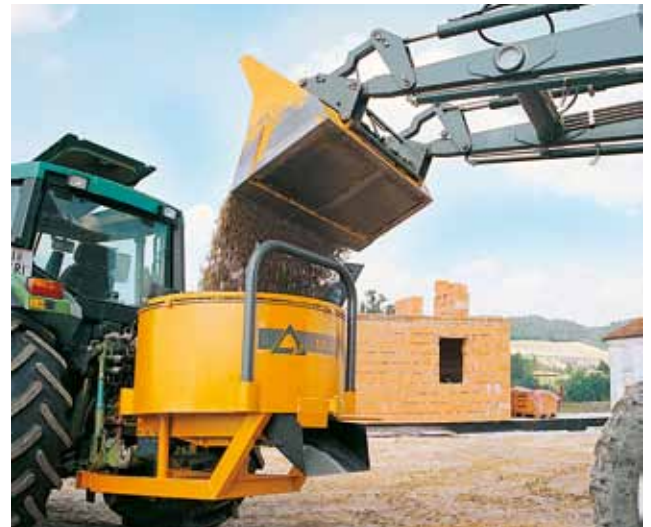
Abb. 11: Zwangsmischer weisen meist einen Nenninhalt über 500 l auf. Der Antrieb über den Traktor erzielt gute Mischergebnisse.
