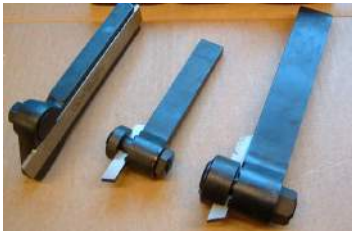
Noževi za blanjanje u specijalnim držalima
