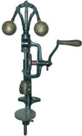
Ručna stolna bušilica iz prelaza 19. na 20. stoljeće
