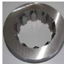
Primjeri obrade dubljenjem u rupama
