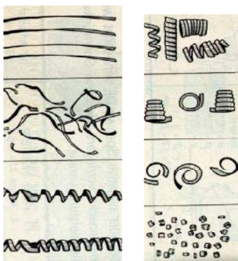
Oblici strugotine ovisе o parametrima obrade
