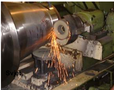
Kružno vanjsko radijalno brušenje
