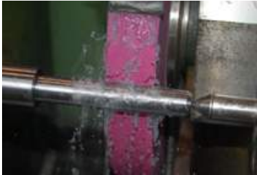
Kružno vanjsko uzdužno brušenje
