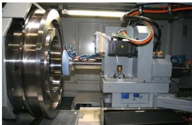
Kružno unutrašnje radijalno brušenje
