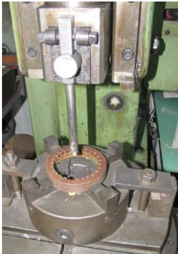
Nož postavljen u dubilicu za obradu utora
