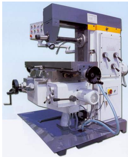
Set za pregradnju univerzalne horizontalne glodalice u vertikalnu glodalicu
