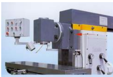
Set za pregradnju univerzalne horizontalne glodalice u vertikalnu glodalicu
