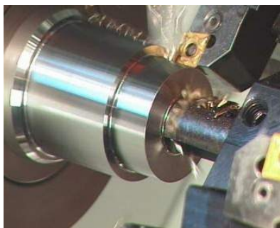
Istovremeno vanjsko i unutarnje tokarenje
