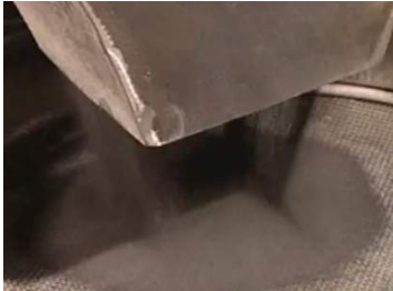
Sijanje smjese brusnih zrnaca za izradu brusne ploče
