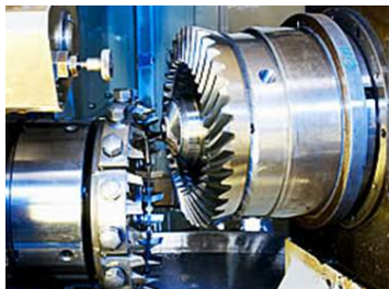
Glodanje zupčanika segmentnim zubima glodala
