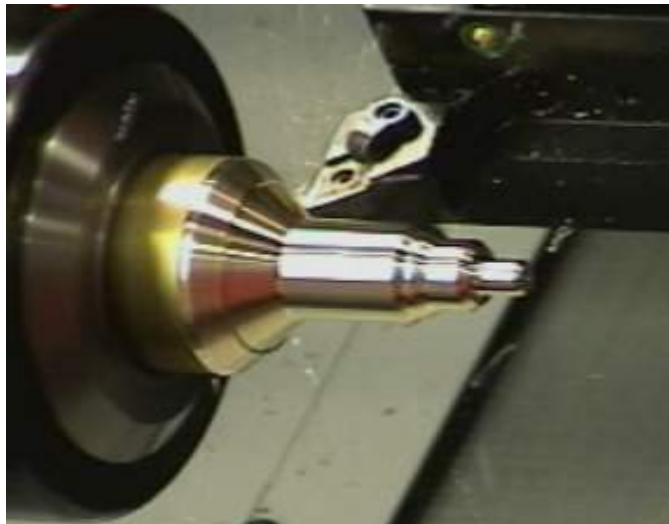
Poprečno tokarenje – izrada utora ili odrezivanje
