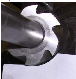
Obodno glodanje – protusmjerno i istosmjerno
