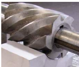
Obodno glodanje – protusmjerno i istosmjerno
