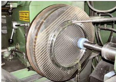
Kružno unutrašnje radijalno brušenje
